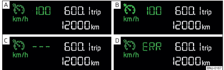
Abb. 121 Segmentdisplay: Beispiele für Zustandsanzeigen der GRA
