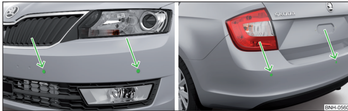
Abb. 115 Einbauort der Sensoren auf der linken Fahrzeugseite: vorn/hinten
