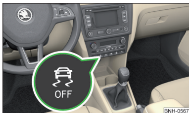
Abb. 114 Systemtaste: ASR deaktivieren/aktivieren
