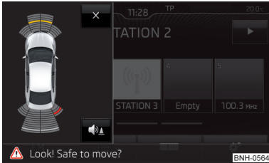
Abb. 119 Infotainmentdisplay: Anzeige bei automatischer Aktivierung
