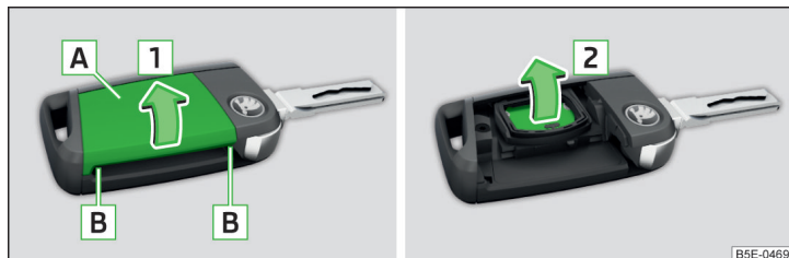
Abb. 169 Abdeckung abbauen / Batterie herausnehmen
