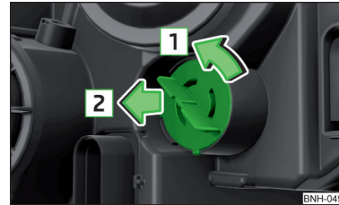
Abb. 184 Glühlampe für Blinklicht vorn wechseln
