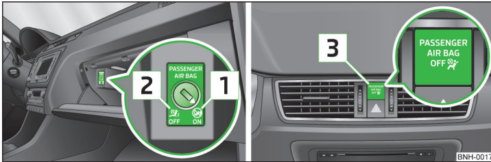
Abb. 12 Schlüsselschalter für Beifahrer-Frontairbag / Kontrollleuchte für Beifahrer-Frontairbagab-/einschaltung
