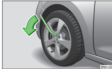
Abb. 129 Radwechsel: Radschrauben lösen
