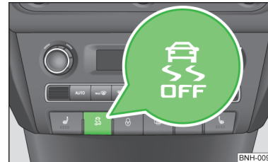
Abb. 95 Taste des ESC-Systems: ASR deaktivieren/aktivieren
