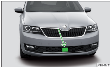
Abb. 197 Verbautort des Radarsensors
