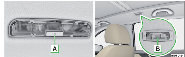
Abb. 60 Innenleuchte hinten: Variante 1 / Variante 2
