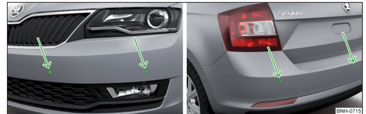
Abb. 202 Verbauort der Sensoren auf der linken Fahrzeugseite: vorn/hinten
