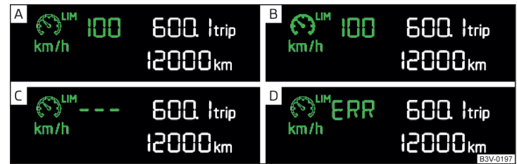
Abb. 213 Segmentdisplay: Beispiele für Zustandsanzeigen des Geschwindigkeitsbegrenzers
