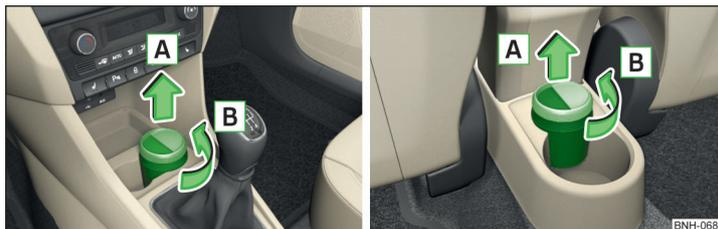
Abb. 72 Aschenbecher vorn/hinten herausnehmen und öffnen
