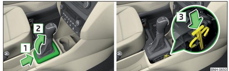
Abb. 180 Abdeckung abnehmen / Wählhebel entriegeln
