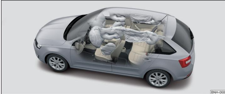
Abb. 8 Gasgefüllte Airbags
