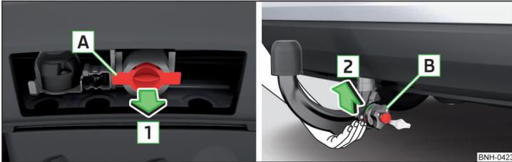
Abb. 139 Abdeckkappe für den Aufnahmeschacht abnehmen / Kugelstange einsetzen
