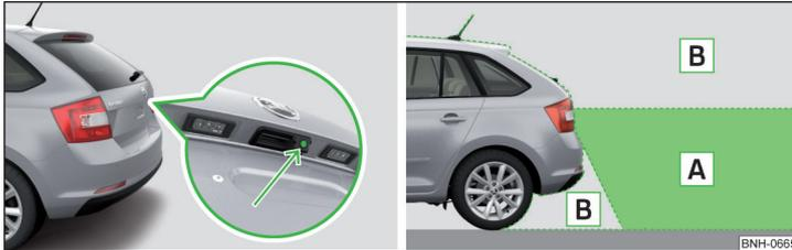
Abb. 121 Verbauplatz der Kamera / Abgetasteter Bereich hinter dem Fahrzeug
