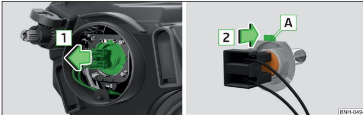
Abb. 191 Glühlampe für Ablendlicht wechseln
