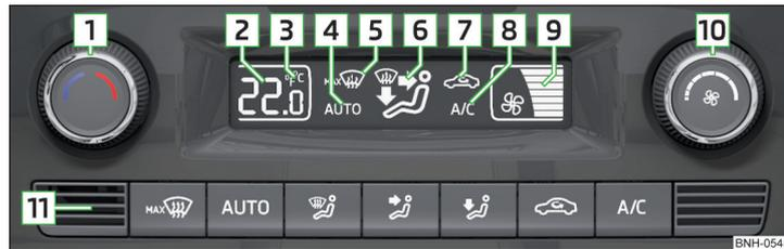
Abb. 102 Bedienelemente der Climatronic
