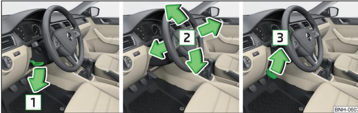
Abb. 3 Lenkradposition einstellen
