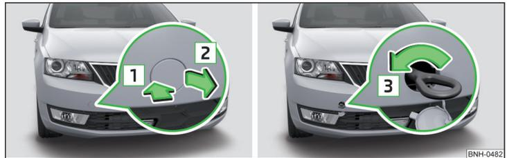
Abb. 174 Abdeckkappe abnehmen / Abschleppöse einbauen
