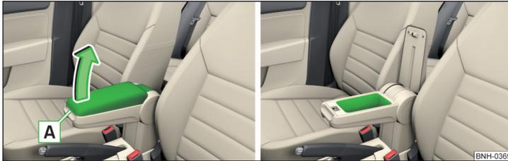
Abb. 75 Ablagefach öffnen / Ablagefach
