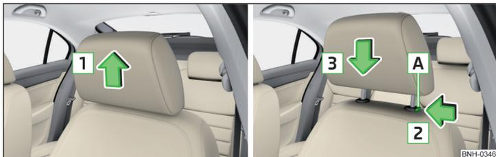
Abb. 58 Höhe der Kopfstütze einstellen
