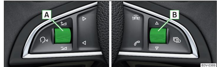
Abb. 25 Tasten/Einstellräder am Multifunktionslenkrad
