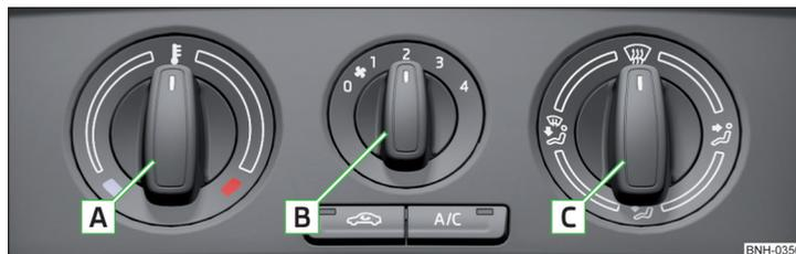
Abb. 101 Bedienungselemente der Heizung/Klimaanlage
