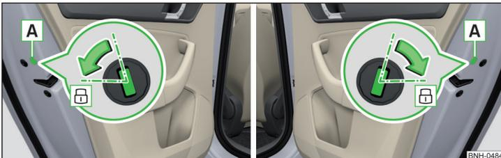
Abb. 178 Notverriegelung: Tür hinten links/rechts
