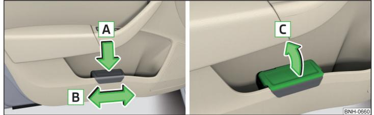
Abb. 69 Abfallbehälter: einsetzen und verschieben / öffnen
