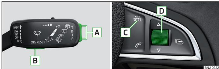
Abb. 132 Tasten/Einstellrad: am Bedienungshebel / am Multifunktionslenkrad
