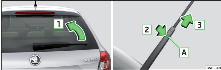
Abb. 183 Scheibenwischerblatt der Heckscheibe auswechseln
