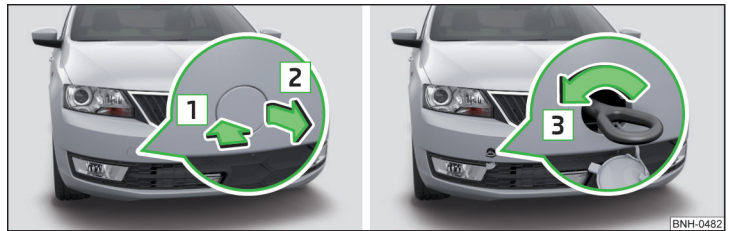
Abb. 174 Abdeckkappe abnehmen / Abschleppöse einbauen
