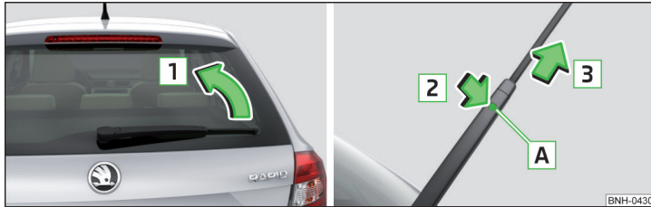
Abb. 183 Scheibenwischerblatt der Heckscheibe auswechseln
