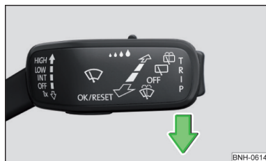
Abb. 181 Servicestellung der Scheibenwischerarme einstellen
