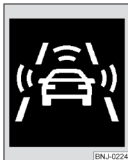
Abb. 131 Display des Kombi-Instruments: Vorwarnung bzw. Notbremsung bei niedriger Geschwindigkeit
