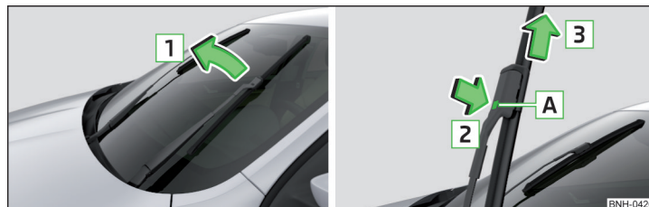
Abb. 182 Scheibenwischerblatt der Frontscheibe austauschen
