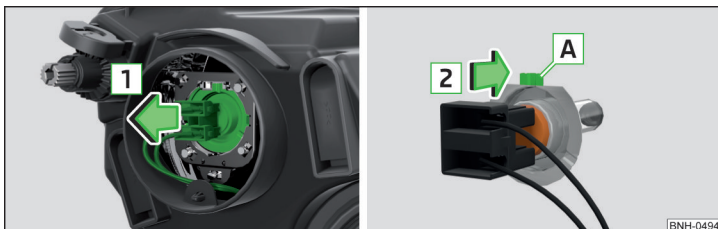
Abb. 191 Glühlampe für Ablendlicht wechseln
