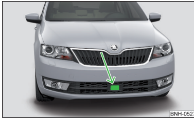
Abb. 129 Verbauort des Radarsensors
