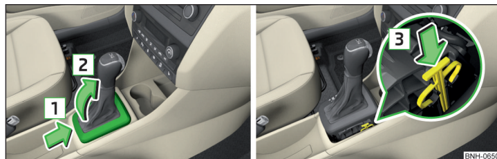
Abb. 180 Abdeckung abnehmen / Wählhebel entriegeln
