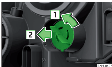
Abb. 194 Glühlampe für Blinklicht vorn wechseln
