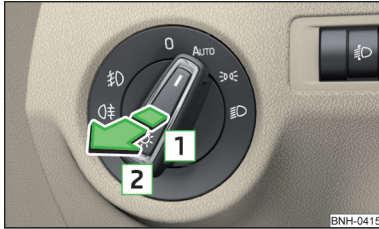
Abb. 43 Lichtschalter - Nebelscheinwerfer/Nebelschlussleuchte einschalten
