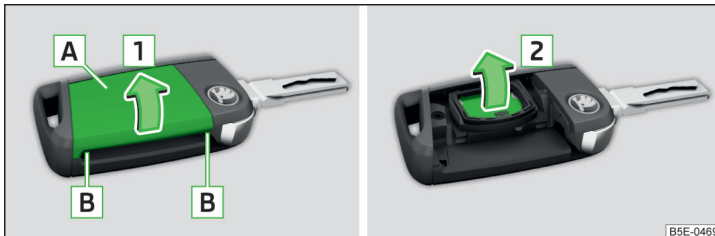
Abb. 176 Abdeckung abnehmen / Batterie herausnehmen
