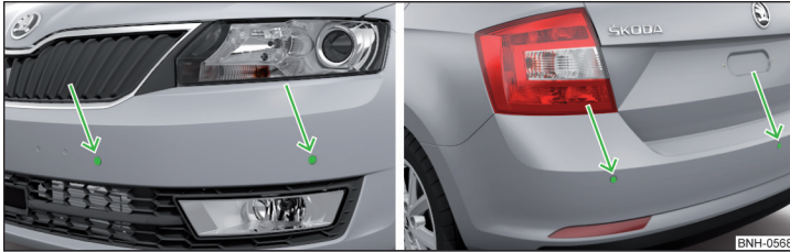
Abb. 116 Verbauport der Sensoren auf der linken Fahrzeugseite: vorn/hinten
