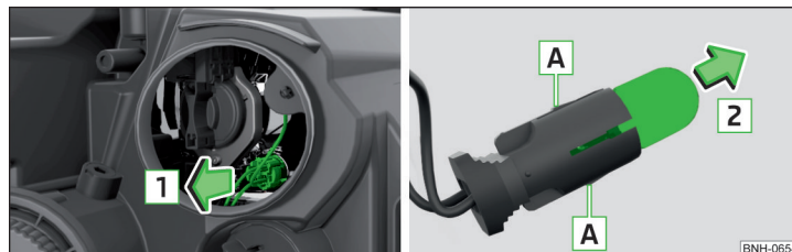
Abb. 193 Glühlampe für Standlicht wechseln
