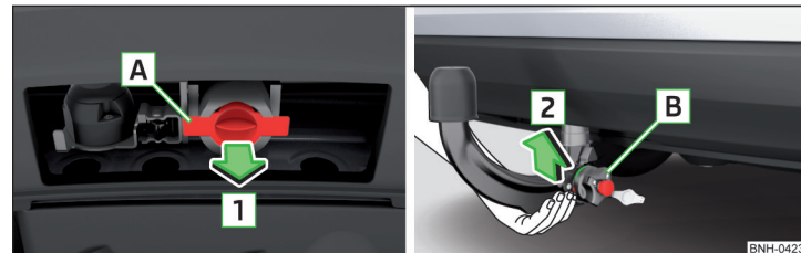
Abb. 115 Abdeckkappe für den Aufnahmeschacht abnehmen / Kugelstange einsetzen
