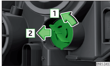
Abb. 165 Glühlampe für Blinklicht vorn wechseln
