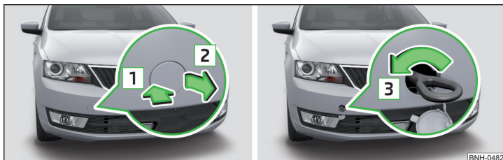
Abb. 149 Ausbau der Abdeckkappe / Einbau der Abschleppöse
