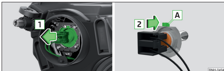
Abb. 162 Glühlampe für Abblendlicht wechseln
