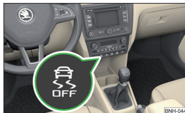
Abb. 105 Taste des ESC-Systems: ASR deaktivieren/aktivieren
