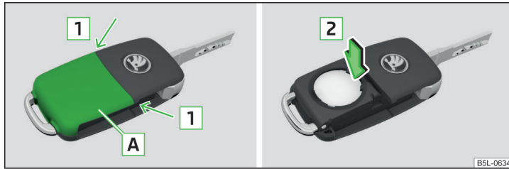
Abb. 151 Abdeckung abbauen / Batterie herausnehmen
