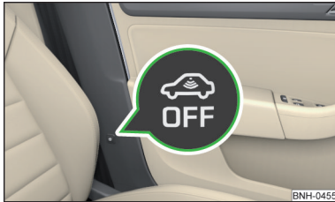
Abb. 35 Taste für Innenraumüberwachung und Abschleppschutz
