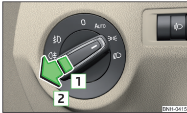
Abb. 42 Lichtschalter - Nebelscheinwerfer und Nebelschlussleuchte einschalten
