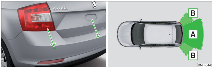
Abb. 106 Einbauort der Sensoren / Reichweite der Sensoren
