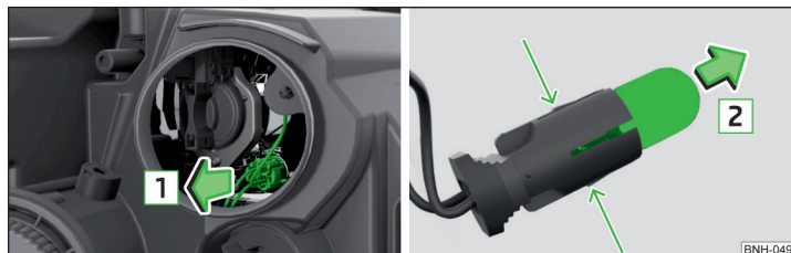
Abb. 164 Glühlampe für Standlicht wechseln
