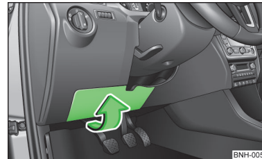
Abb. 154 Unterseite der Schalttafel: Abdeckung des Sicherungskastens
