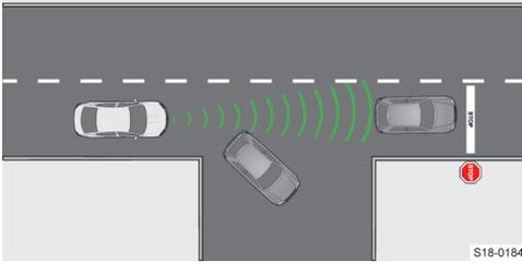
Wenn ein vorausfahrendes Fahrzeug abbiegt und sich vor diesem Fahrzeug ein stehendes Fahrzeug befindet, reagiert die ACC auf das stehende Fahrzeug nicht.
