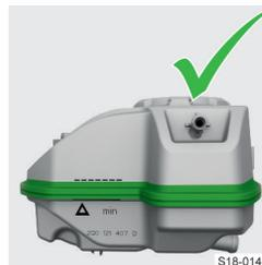
Der Füllstand muss im markierten Bereich liegen.
