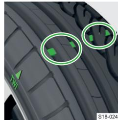
Im Profilgrund der Bereifung befinden sich Verschleißanzeiger, die die zulässige Mindestprofiltiefe anzeigen.
