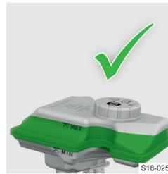
Der Füllstand muss im markierten Bereich liegen.
