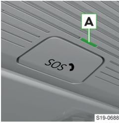
Der Systemzustand wird nach dem Einschalten der Zündung durch Aufleuchten der Kontrollleuchte **A** angezeigt.
