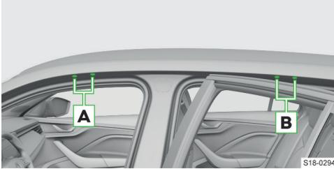
Die Dachquerträger können ausstattungsabhängig an den Befestigungspunkten **A** und **B** befestigt werden.
