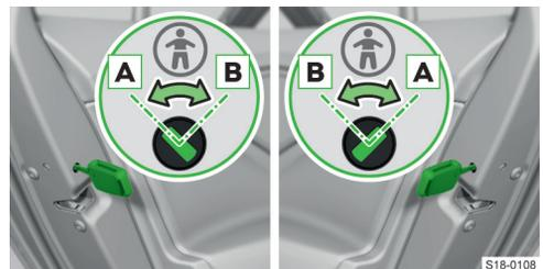
▶ Die Sicherung mit dem Fahrzeugschlüssel oder einem Schlitzschraubendreher drehen.
