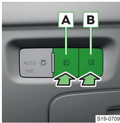
Schalter für Nebelscheinwerfer/Nebelschlussleuchte
