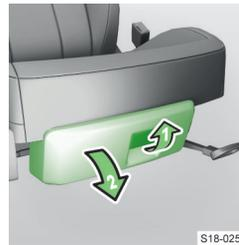
Die maximale Belastung des Ablagefachs beträgt 1,5 kg.
