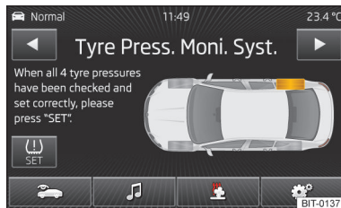
Abb. 46 Reifendruckkontrollanzeige - Darstellungsbeispiel: das System weist auf eine Reifendruckänderung hinten rechts hin
