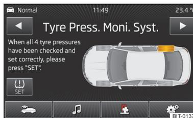
Abb. 46 Reifendruckanzeige - Darstellungsbeispiel: den Reifen hinten rechts und dessen Fülldruck prüfen
