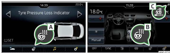
Abb. 96 Lenkradheizung: Manuelle Klimaanlage / Climatronic
