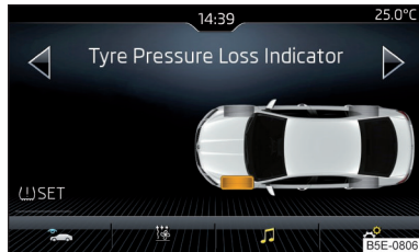
Abb. 295 Taste für Speicherung / Beispiel der Bildschirmanzeige: es wird auf eine Reifendruckänderung vorn links hingewiesen
