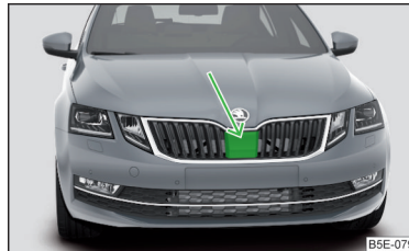
Abb. 250 Verbauport des Radarsensors
