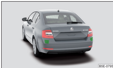
Abb. 258 Verbauter der Radarsensoren
