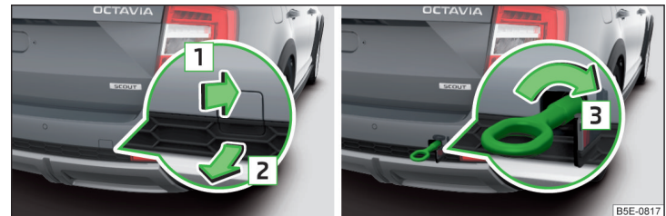
Abb. 339 Abdeckkappe abnehmen / Abschleppöse einbauen - Variante 2
