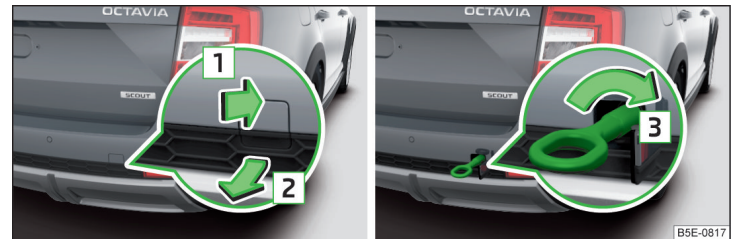
Abb. 340 Abdeckkappe abnehmen / Abschleppöse einbauen - Variante 2
