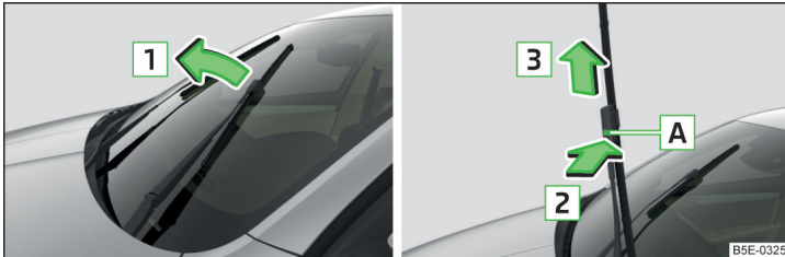
Abb. 348 Scheibenwischerblatt der Frontscheibe auswechseln
