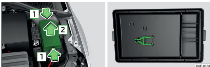
Abb. 354 Abdeckung des Sicherungskastens: Abdeckung abnehmen / Kunststoffklammer für Sicherungen
