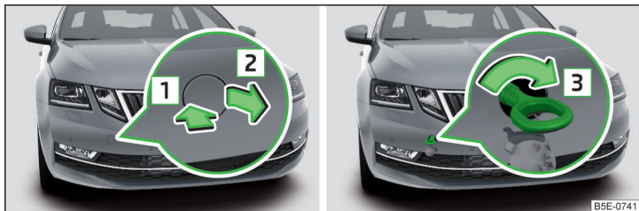
Abb. 337 Abdeckkappe abnehmen / Abschleppöse einbauen
