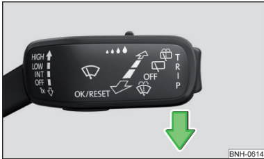
Abb. 347 Servicestellung der Scheibenwischerarme einstellen
