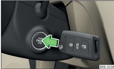
Abb. 238 Motor anlassen - Knopf mit dem Schlüssel drücken
