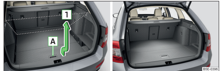
Abb. 140 Variablen Ladeboden in die obere Position einstellen / Variabler Ladeboden in der oberen Position
