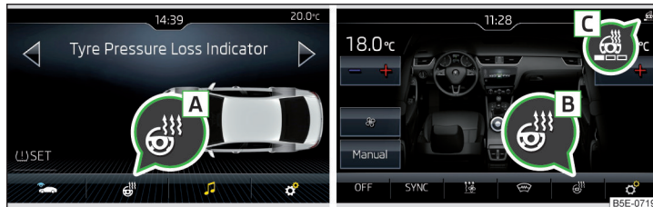
Abb. 91 Lenkradheizung: Manuelle Klimaanlage / Climatronic
