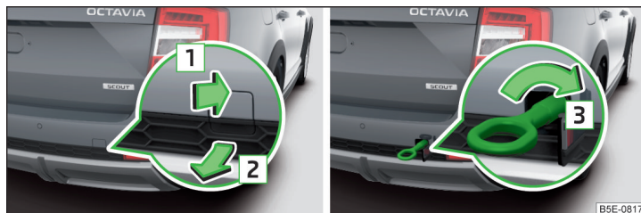
Abb. 339 Abdeckkappe abnehmen / Abschleppöse einbauen - Variante 2
