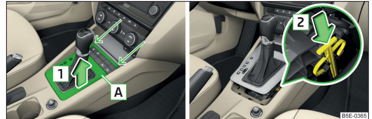
Abb. 346 Abdeckung lösen / Wählhebel entriegeln
