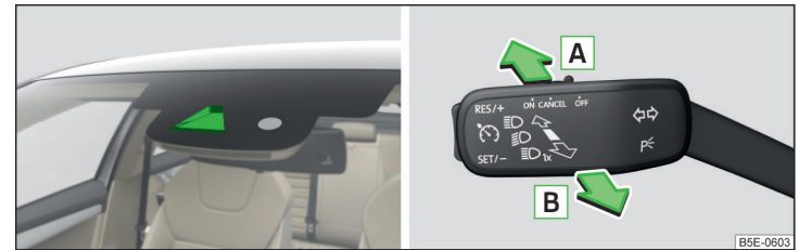
Abb. 65 Verbauplatz des Sensors / System ein-/ausschalten
