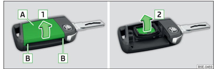
Abb. 340 Abdeckung aufklappen / Batterie herausnehmen
