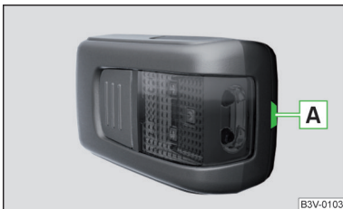
Abb. 342 Arretierungsclip an der Akkuabdeckung
