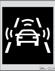
Abb. 290 Display im Kombi-Instrument: Vorwarnung bzw. Notbremsung bei niedriger Geschwindigkeit
