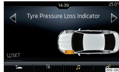
Abb. 299 Taste für Speicherung / Beispiel der Bildschirmanzeige: es wird auf eine Reifendruckänderung vorn links hingewiesen
