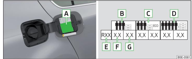
Abb. 297 **Aufkleber mit einer Tabelle der Reifenfülldruckwerte / Reifen aufpumpen**
