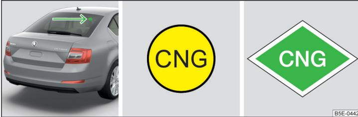
Abb. 289 Position des CNG-Aufklebers / CNG-Aufkleber
