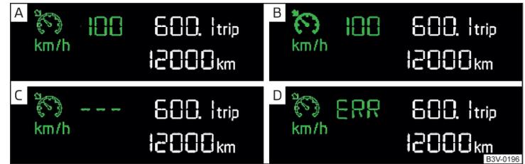
Abb. 253 Segmentdisplay: Beispiele für Zustandsanzeigen der GRA
