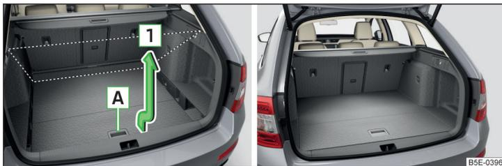
Abb. 119 Variablen Ladeboden in die obere Position einstellen / Variabler Ladeboden in der oberen Position
