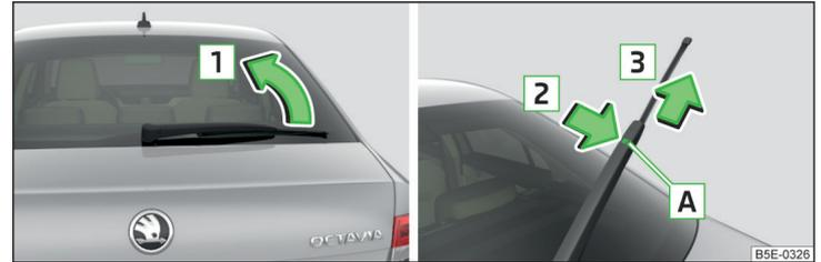
Abb. 323 Scheibenwischerblatt der Heckscheibe auswechseln
