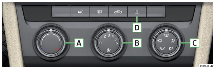
Abb. 128 Bedienungselemente der Heizung/Klimaanlage
