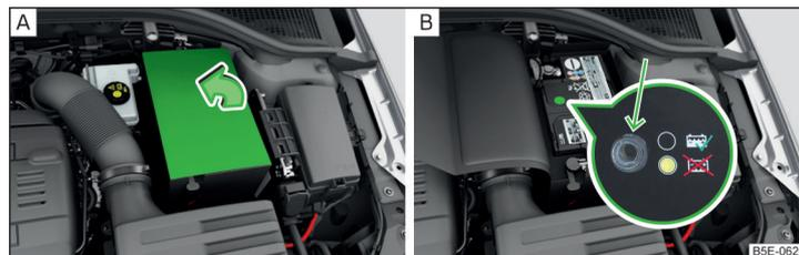
Abb. 296 Fahrzeugbatterie: Abdeckung aufklappen / Säurestandsanzeige
