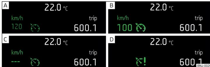
Abb. 252 MAXI DOT-Display (monochromatisch): Beispiele für Zustandsanzeigen der GRA
