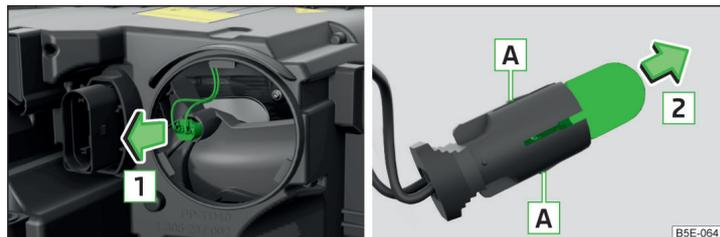
Abb. 333 Glühlampe für zusätzliches Standlicht wechseln
