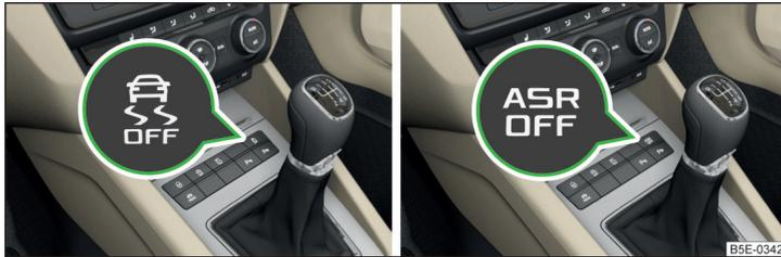
Abb. 241 Systemtaste: Fahrzeug mit ESC / Fahrzeug ohne ESC
