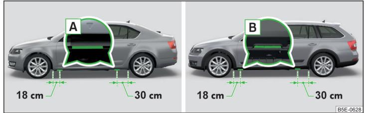
Abb. 307 Aufnahme­stege für den Wagenheber: Variante 1 / Variante 2
