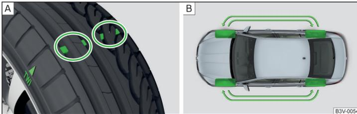
Abb. 298 Reifenverschleißanzeiger / Rädertausch
