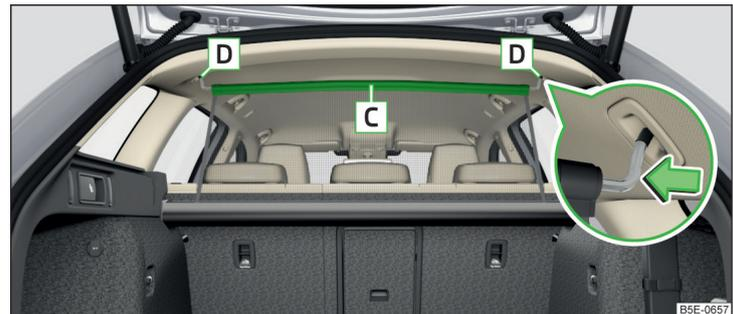
Abb. 124 Korrekt gesicherte Netztrennwand hinter den Rücksitzen im herausgezogenen Zustand
