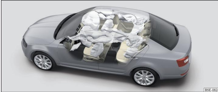
Abb. 8 Gasgefüllte Airbags
