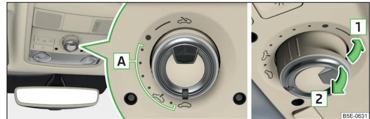
Abb. 43 Bedienung des Schiebe-/Ausstelldachs
