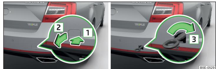
Abb. 314 Abdeckkappe abnehmen / Abschleppöse einbauen - Variante 2
