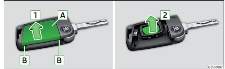
Abb. 315 Abdeckung abnehmen / Batterie herausnehmen
