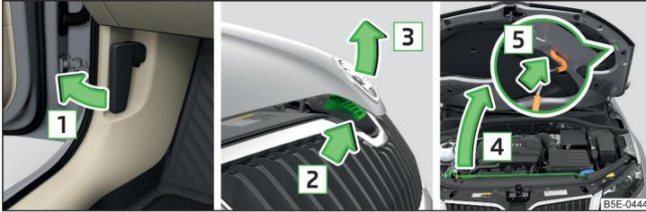
Abb. 290 Motorraumklappe öffnen
