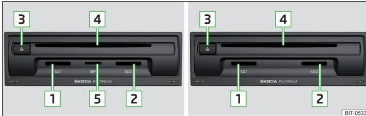
Abb. 142 Externes Modul: Infotainment Columbus mit SIM-Kartenschacht / Infotainment Columbus ohne SIM-Kartenschacht
