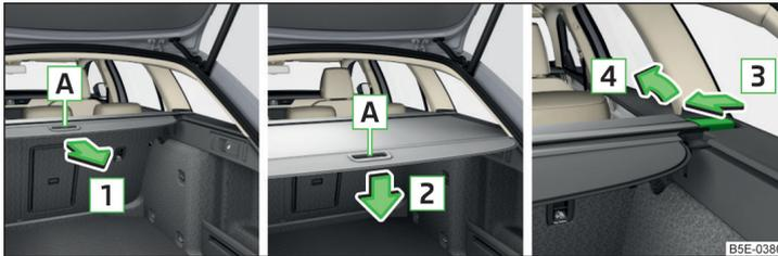
Abb. 113 Aufrollbare Abdeckung: herausziehen / aufrollen / herausnehmen
