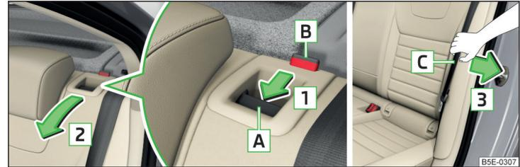
Abb. 68 Sitzlehne vom Fahrgastraum aus vorklappen / Gurt zur Seitenverkleidung ziehen
