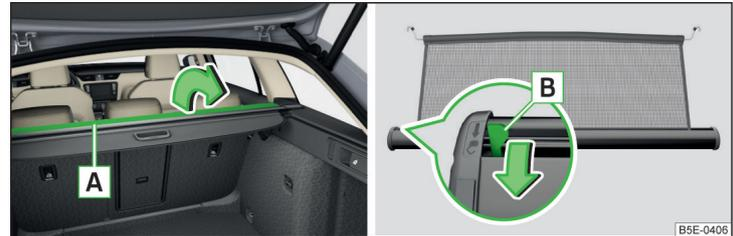
Abb. 123 Teil der aufrollbaren Gepäckraumabdeckung aufklappen / Entriegelungshebel
