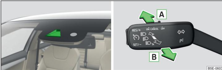
Abb. 49 Sensorsichtfenster für den Fernlichtassistenten / System ein-/ausschalten
