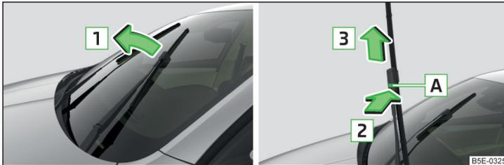
Abb. 322 Scheibenwischerblatt der Frontscheibe auswechseln
