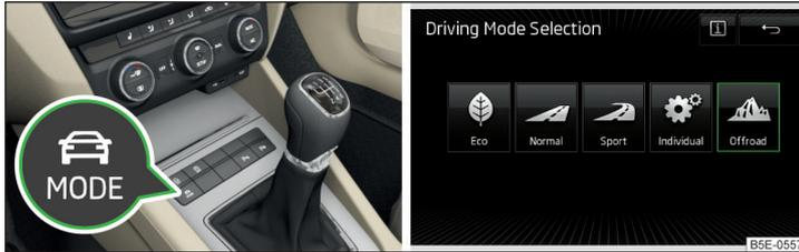
Abb. 242 Taste für die Auswahl des Fahrmodus / Funktionsfläche im Infotainmentschirm
