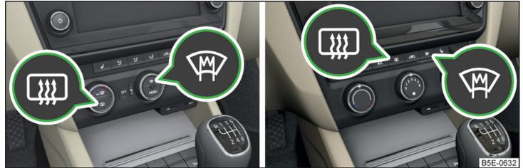
Abb. 55 Tasten für die Front- und Heckscheibenbeheizung: Climatronic / manuelle Klimaanlage, Heizung
