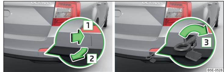
Abb. 313 Abdeckkappe abnehmen / Abschleppöse einbauen - Variante 1
