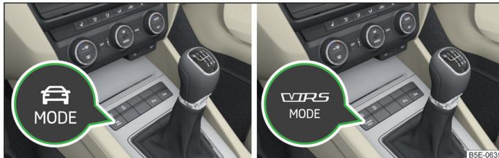
Abb. 262 Taste für die Auswahl des Fahrmodus: Variante 1 / Variante 2
