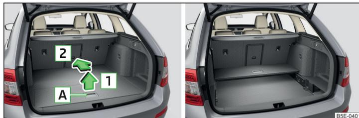
Abb. 121 Variablen Ladeboden zusammenklappen / Zusammengeklappter variabler Ladeboden in der oberen Position
