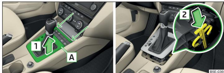
Abb. 320 Abdeckung abnehmen / Wählhebel entriegeln
