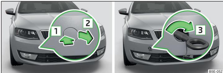
Abb. 312 Abdeckkappe abnehmen / Abschleppöse einbauen
