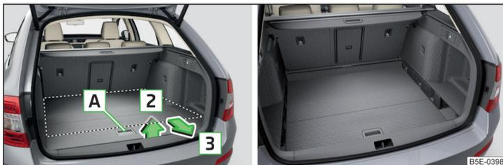
Abb. 120 Variablen Ladeboden in die untere Position einstellen / Variabler Ladeboden in der unteren Position
