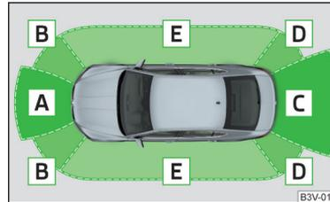
Abb. 244 Abgetastete Bereiche und Reichweite der Sensoren
