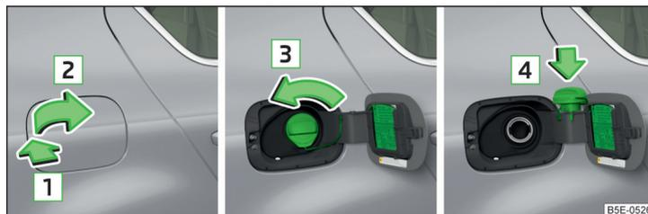
Abb. 286 Tankklappe aufklappen / Tankverschluss herausdrehen / Tankverschluss auf die Tankklappe stecken
