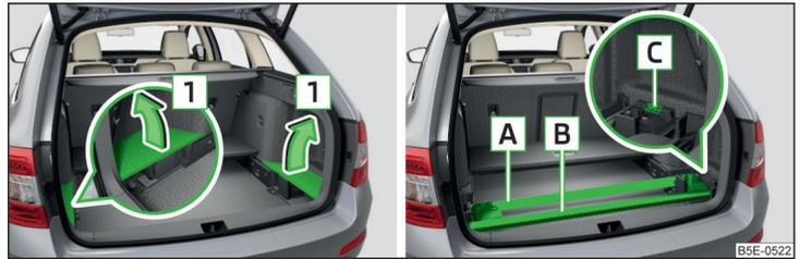
Abb. 127 Seitenabdeckungen des Gepäckraums herausnehmen / Dachgepäckträger verstauen
