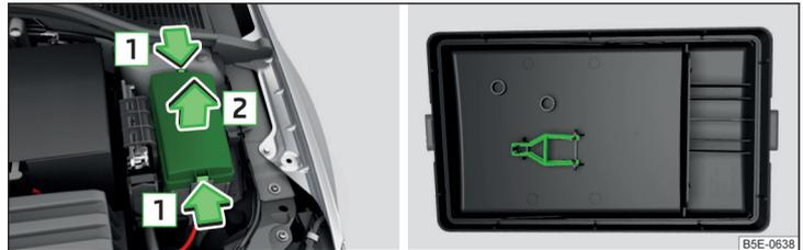
Abb. 328 Abdeckung des Sicherungskastens: Abdeckung abnehmen / Kunststoffklammer für Sicherungen
