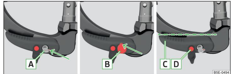
Abb. 273 Bereitschaftsstellung: Schlüsselvariante 1 / Schlüsselvariante 2 / Stellung des Hebels und des Auslösebolzens bei beiden Schlüsselvarianten
