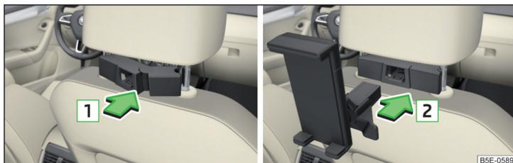
Abb. 98 Einsetzen: Adapter / Halter
