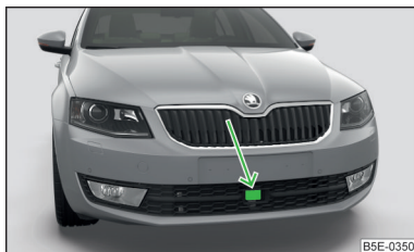
Abb. 143 Verbauort des Radarsensors
