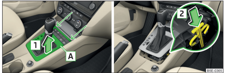
Abb. 224 Abdeckung abnehmen / Wählhebel entriegeln
