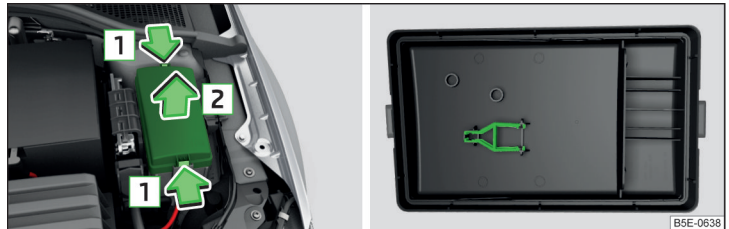
Abb. 232 Abdeckung des Sicherungskastens: Abdeckung abnehmen / Kunststoffklammer für Sicherungen
