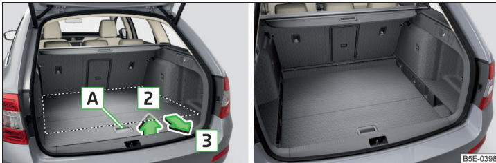
Abb. 118 Variablen Ladeboden in die untere Position einstellen / Variabler Ladeboden in der unteren Position
