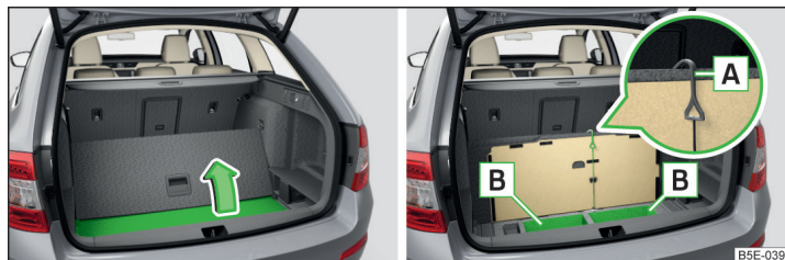
Abb. 115 Bodenbelag anheben / Ablagefächer unter dem Bodenbelag
