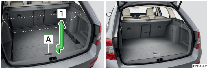
Abb. 117 Variablen Ladeboden in die obere Position einstellen / Variabler Ladeboden in der oberen Position
