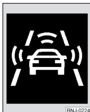
Abb. 164 Display im Kombi-Instrument: Vorwarnung bzw. Notbremsung bei niedriger Geschwindigkeit
