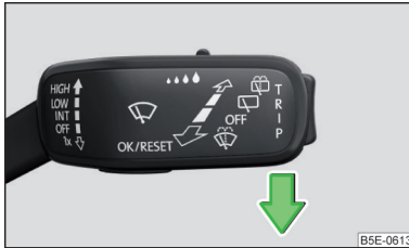
Abb. 225 Servicestellung der Scheibenwischerarme einstellen
