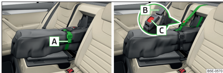
Abb. 91 Band anziehen / Durchladesack sichern
