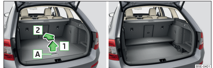
Abb. 119 Variablen Ladeboden zusammenklappen / Zusammengeklappter variabler Ladeboden in der oberen Position
