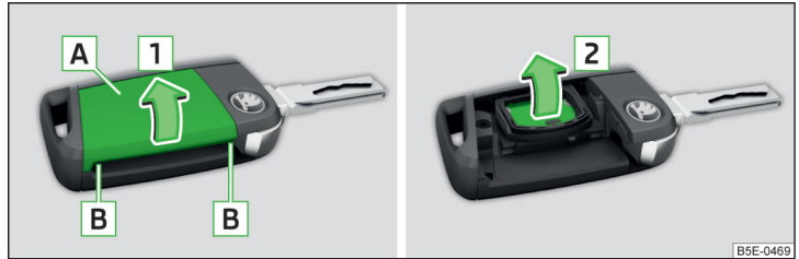
Abb. 219 Abdeckung abnehmen / Batterie herausnehmen
