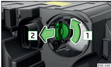
Abb. 236 Glühlampe für Fern-, Tagfahr- und Standlicht wechseln
