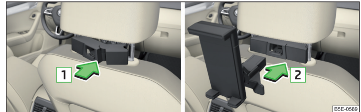
Abb. 96 Einsetzen: Adapter / Halter
