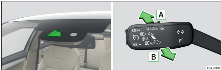
Abb. 47 Sensordachfenster für den Fernlichtassistenten / System ein-/ausschalten
