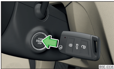
Abb. 133 Motor anlassen - Knopf mit dem Schlüssel drücken
