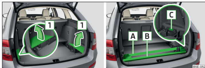
Abb. 125 Seitenabdeckungen des Gepäckraums herausnehmen / Dachgepäckträger verstauen
