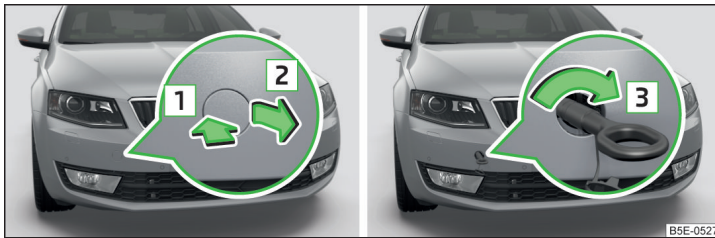
Abb. 216 Abdeckkappe abnehmen / Abschleppöse einbauen
