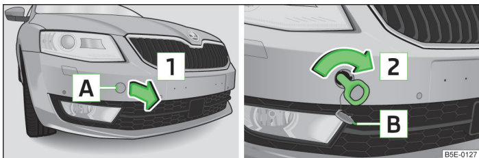
Abb. 203 Vorderer Stoßfänger: Ausbau der Abdeckkappe / Einbau der Abschleppöse
