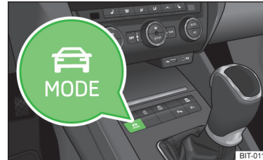
Abb. 10 Mittelkonsole: Taste für die Auswahl des Fahrmodus
