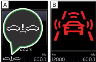
Das System Front Assist zeigt im Display des Kombi-Instruments eine Warnung vor der Gefahr einer Kollision mit einem Fahrzeug oder mit einem anderen vor Ihnen befindlichen Hindernis an.
