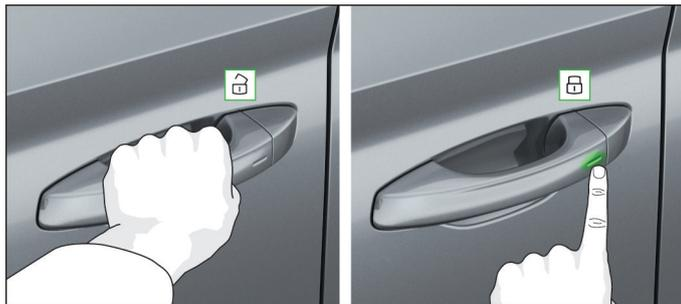
Das System KESSY ermöglicht mithilfe von Sensoren im Griff der beiden Vordertüren eine Entriegelung bzw. Verriegelung des Fahrzeugs ohne die aktive Verwendung des Schlüssels.
