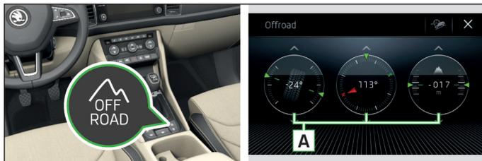
Der OFF ROAD-Modus unterstützt den Fahrer beim Passieren schwierig befahrbarer Strecken bei einer Geschwindigkeit bis 30 km/h.
