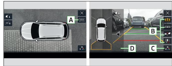
Während eines Rangiervorgangs wird die von Kameras erfasste Fahrzeugumgebung vom System im Infotainmentbildschirm angezeigt.
