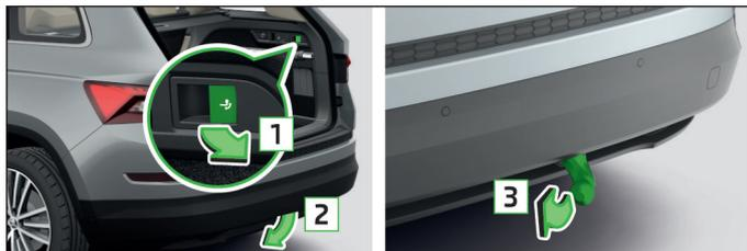
▶ Am Schalter in Pfeilrichtung **1** ziehen (der Verbauort des Schalters kann ausstattungsabhängig unterschiedlich sein).
