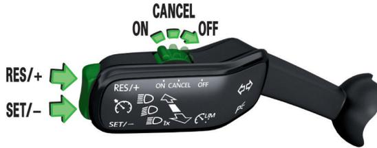
Die Geschwindigkeitsregelanlage regelt die eingestellte Geschwindigkeit, ohne dass das Gaspedal betätigt werden muss. Während der Regelung leuchtet im Kombi-Instrument die Kontrollleuchte
