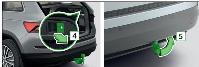
An der Kugelstange darf kein Anhänger bzw. kein anderes Zubehör angekuppelt sein. In der 13-poligen Steckdose darf kein Stecker oder Adapter eingesteckt sein.
