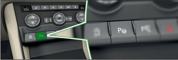
Der Anhängerrangierassistent (nachstehend nur System) unterstützt den Fahrer beim Rückwärtsfahren mit einem Anhänger.
