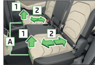
➤ Zum **Einstellen in Längsrichtung** den Hebel **A** in Pfeilrichtung **1** ziehen und den Sitz in die gewünschte Position in Pfeilrichtung **2** verschieben.
