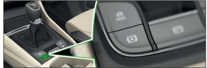
Die Auto Hold Funktion sichert das Fahrzeug beim Anhalten gegen Wegrollen. Die Sicherung des Fahrzeugs wird durch Aufleuchten der Kontrollleuchte (A) im Kombi-Instrument angezeigt.
