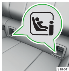
Halteösen für den Einbau des Kindersitzes mit dem ISOFIX-System.
