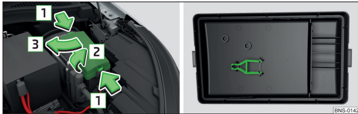
Abb. 366 Abdeckung des Sicherungskastens: Abdeckung abnehmen / Kunststoffklammer für Sicherungen
