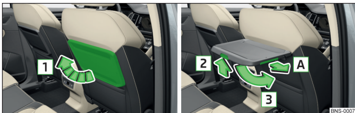
Abb. 127 Tisch hochklappen / Tisch herunterklappen und Getränkehalter herauschieben
