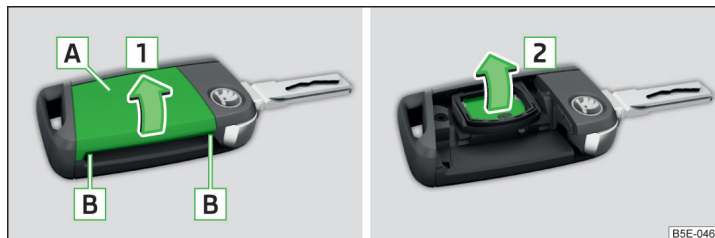
Abb. 349 Abdeckung aufklappen / Batterie herausnehmen
