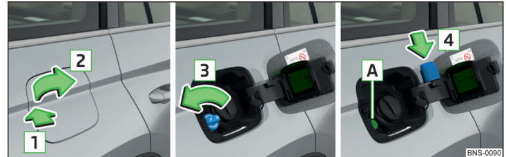
Abb. 321 Tankklappe aufklappen / Tankverschluss herausdrehen / Tankverschluss auf die Tankklappe stecken
