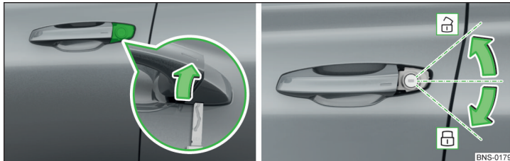
Abb. 354 Griff an der Fahrtür: Schlossabdeckung aufklappen / ent- und verriegeln
