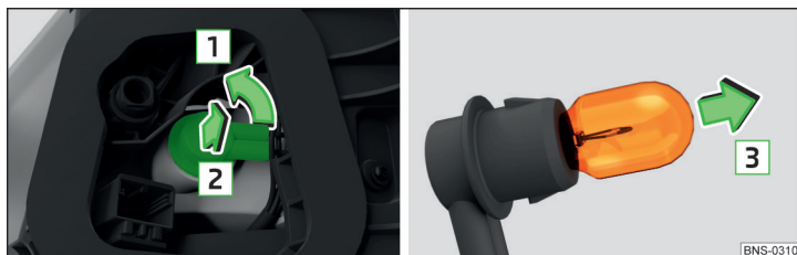
Abb. 377 Glühlampe wechseln / Leuchte einbauen
