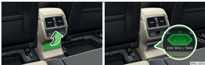
Abb. 133 Abdeckung der 230-Volt-Steckdose aufklappen / 230-Volt-Steckdose
