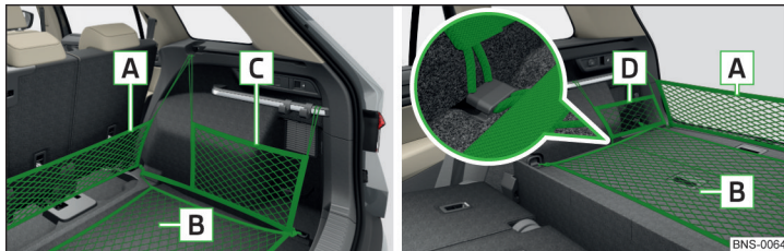
Abb. 142 Befestigungsbeispiele für Netze: Fünfsitzer-Variante / Fünfsitzer-Variante mit dem variablen Ladeboden
