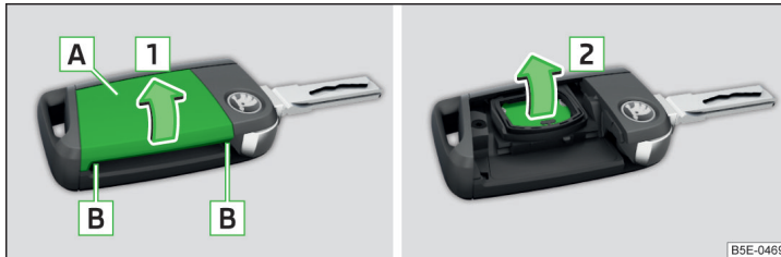
Abb. 348 Abdeckung aufklappen / Batterie herausnehmen
