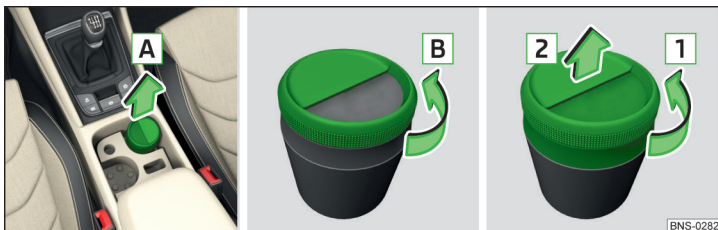
Abb. 134 Aschenbecher herausnehmen / öffnen / zerlegen
