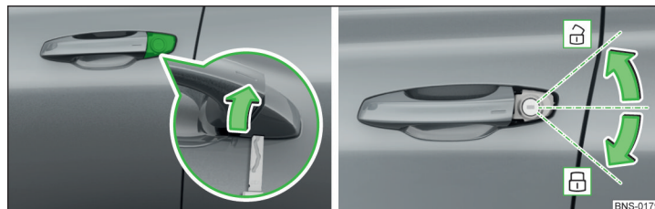
Abb. 353 Griff an der Fahrtür: Schlossabdeckung aufklappen / ent- und verriegeln
