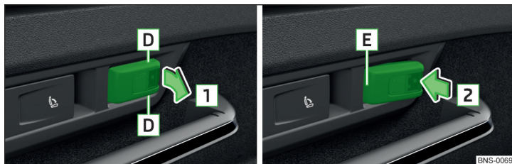
Abb. 153 Leuchte herausnehmen / Leuchte einsetzen
