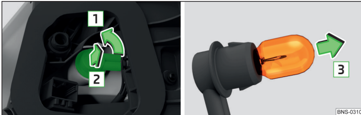
Abb. 376 Glühlampe wechseln / Leuchte einbauen
