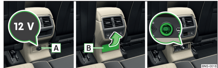
Abb. 131 Abdeckung der 12-Volt-Steckdose / Abdeckung der 12-Volt-Steckdose aufklappen
