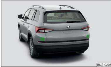
Abb. 271 Verbauort der Radarsensoren
