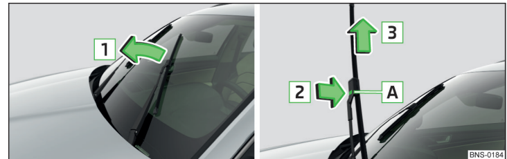
Abb. 359 Scheibenwischerblatt der Frontscheibe austauschen
