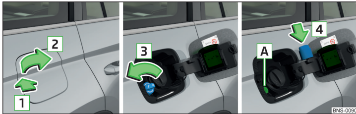
Abb. 322 Tankklappe aufklappen / Tankverschluss herausdrehen / Tankverschluss auf die Tankklappe stecken
