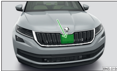
Abb. 262 Verbautort des Radarsensors
