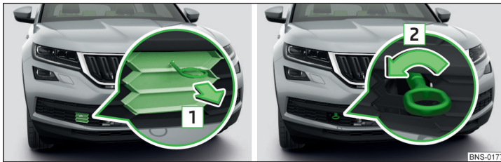
Abb. 346 Schutzgitter abnehmen / Abschleppöse einbauen
