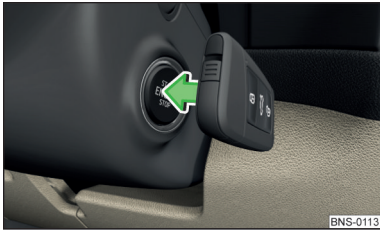
Abb. 250 Motor anlassen - Schlüssel an den Knopf halten
