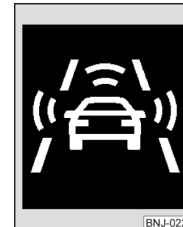
Abb. 306 Display des Kombi-Instruments: Vorwarnung bzw. Notbremsung bei niedriger Geschwindigkeit
