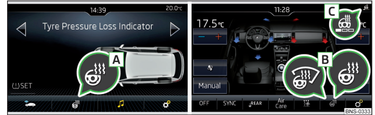
Abb. 105 Lenkradheizung: Manuelle Klimaanlage / Climatronic
