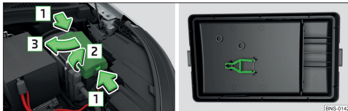
Abb. 365 Abdeckung des Sicherungskastens: Abdeckung abnehmen / Kunststoffklammer für Sicherungen
