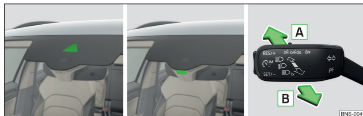
Abb. 69 Verbauartvarianten des Sensors / System ein-/ausschalten
