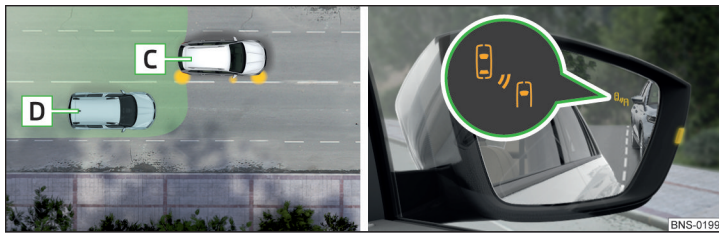
Abb. 274 Fahrsituation / Kontrollleuchte im rechten Außenspiegel weist auf die Fahrsituation hin
