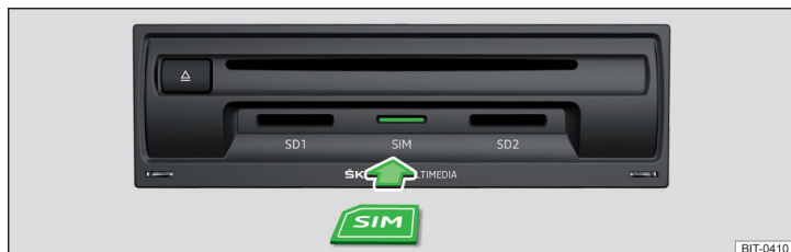
Abb. 194 SIM-Karte in das externe Modul einstecken
