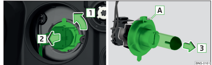
Abb. 376 Glühlampe für Fernlicht wechseln
