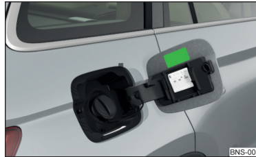
Abb. 325 Aufkleber mit vorgeschriebenem Kraftstoff
