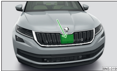
Abb. 264 Verbautort des Radarsensors
