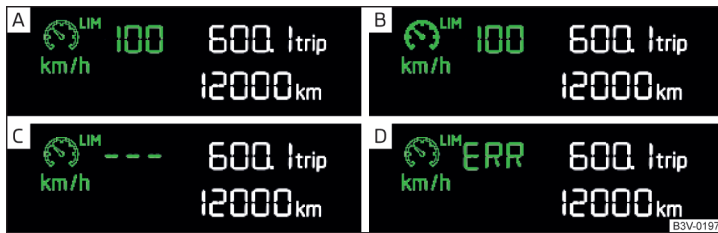
Abb. 300 Segmentdisplay: Beispiele für Zustandsanzeigen des Geschwindigkeitsbegrenzers
