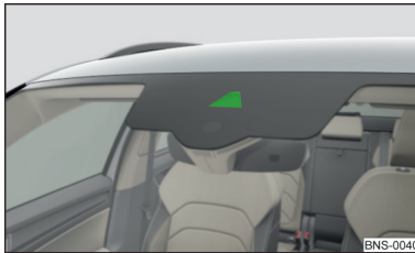
Abb. 316 Sensor für die Verkehrszeichenerkennung
