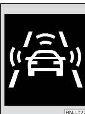
Abb. 310 Display des Kombi-Instruments: Vorwarnung bzw. Notbremsung bei niedriger Geschwindigkeit
