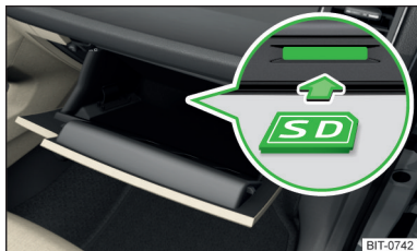
Abb. 181 Infotainment Columbus, Amundsen, Bolero: SD-Karte einschieben
