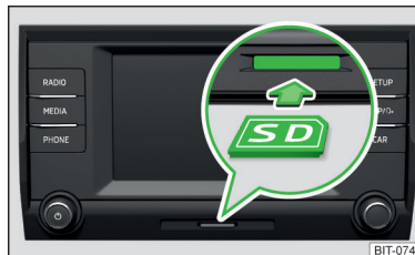
Abb. 182 Infotainment Swing: SD-Karte einschieben
