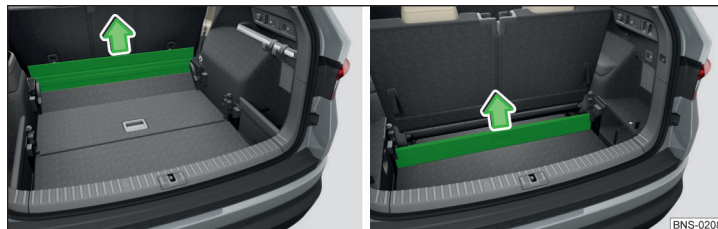
Abb. 144 Trennwand abnehmen: Fünfsitzer-Variante/Siebensitzer-Variante
