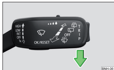
Abb. 364 Servicestellung der Scheibenwischerarme einstellen
