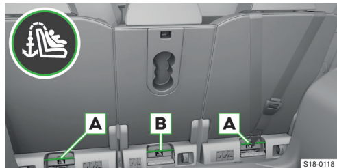
Halteösen an den VarioFlex-Rücksitzen
