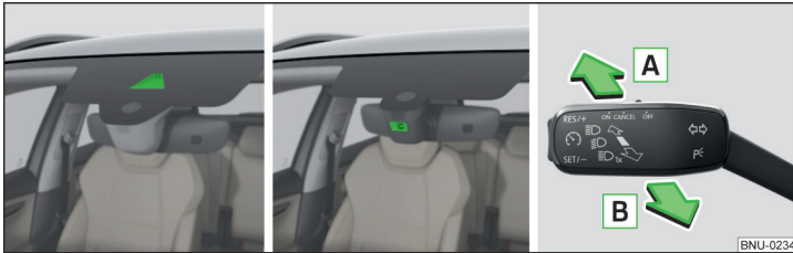
Abb. 65 Verbauartvarianten des Sensors / System ein-/ausschalten
