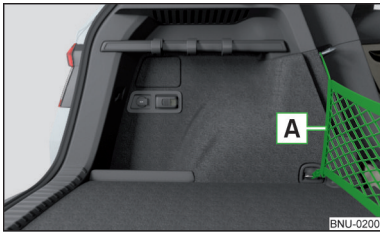
Abb. 139 Befestigungsbeispiele für Netze: Variante 3
