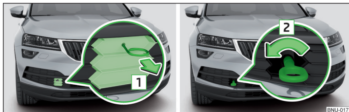
Abb. 328 Schutzgitter abnehmen / Abschleppöse einbauen
