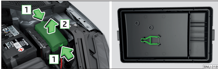
Abb. 344 Abdeckung des Sicherungskastens: Abdeckung abnehmen / Kunststoffklammer für Sicherungen
