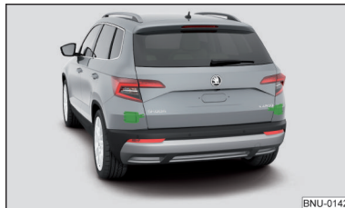
Abb. 266 Verbauort der Radarsensoren
