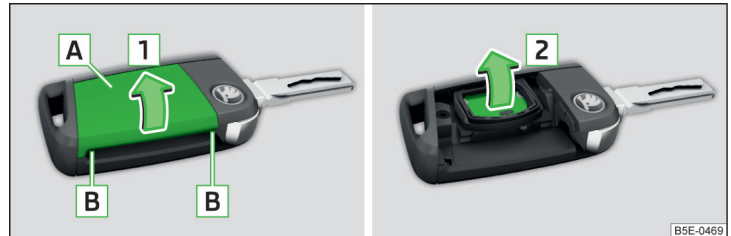
Abb. 330 Abdeckung aufklappen / Batterie herausnehmen
