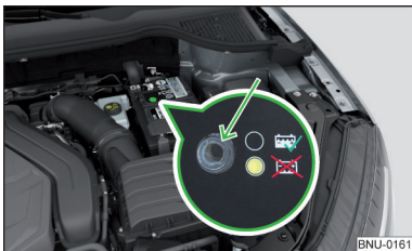
Abb. 311 Fahrzeugbatterie: Säurestands- anzeige
