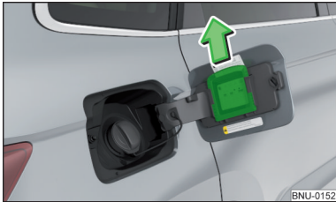
Abb. 300 Verbauort des Eiskratzers, Eis- kratzer abnehmen
