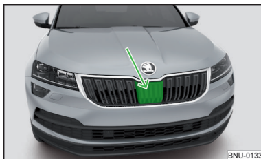
Abb. 257 Verbauort des Radarsensors
