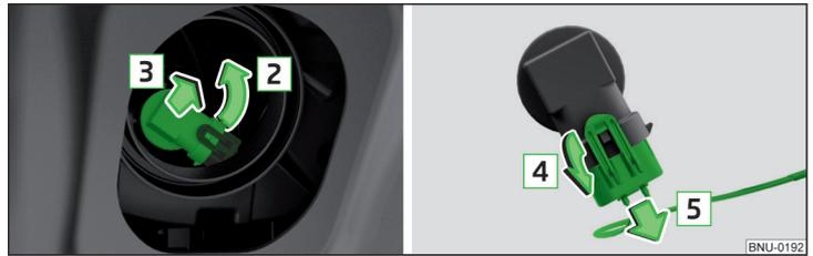
Abb. 347 Glühlampe für Nebelscheinwerfer wechseln
