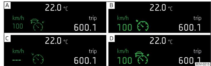
Abb. 280 Display des Kombi-Instruments: Beispiele für Zustandsanzeigen der ACC
