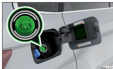
Abb. 299 Kraftstoffeinfüllstutzen bei Fahrzeugen mit Dieselmotoren
