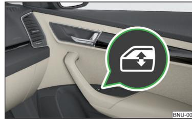
Abb. 57 Taste des Fensterhebers auf der Beifahrerseite
