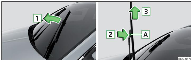
Abb. 334 **Scheibenwischerblatt der Frontscheibe auswechseln**
