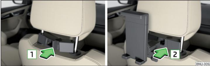
Abb. 127 Einsetzen: Adapter / Halter
