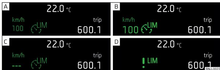
**Abb. 275** Display des Kombi-Instruments: Beispiele für Zustandsanzeigen des Geschwindigkeitsbegrenzers
