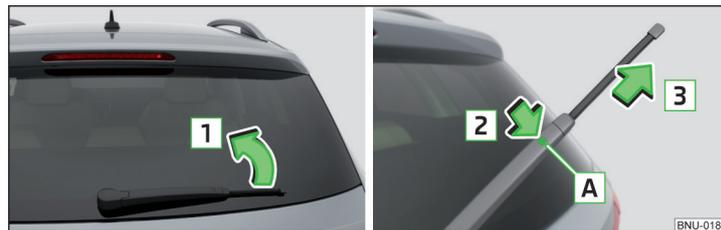
Abb. 335 **Scheibenwischerblatt der Heckscheibe auswechseln**
