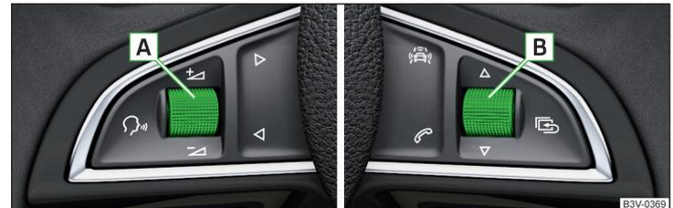
Abb. 42 **Tasten/Einstellräder am Multifunktionslenkrad**
