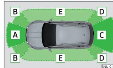
**Abb. 258** Abgetastete Bereiche und Reichweite der Sensoren
