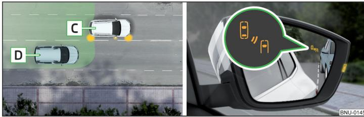
Abb. 265 Fahrsituation / Kontrollleuchte im rechten Außenspiegel weist auf die Fahrsituation hin
