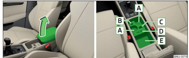
Abb. 110 Ablagefach öffnen / Innenraum des Fachs
