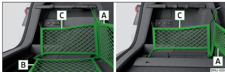
Abb. 133 Befestigungsbeispiele für Netze: Variante 1 / Variante 2
