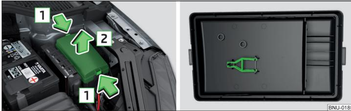
Abb. 340 Abdeckung des Sicherungskastens: Abdeckung abnehmen / Kunststoffklammer für Sicherungen
