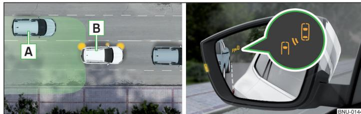
Abb. 264 Fahrsituation / Kontrollleuchte im linken Außenspiegel weist auf die Fahrsituation hin
