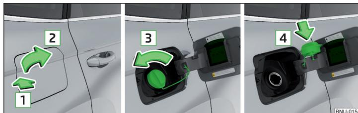
Abb. 298 Tankklappe aufklappen / Tankverschluss herausdrehen / Tankverschluss auf die Tankklappe stecken
