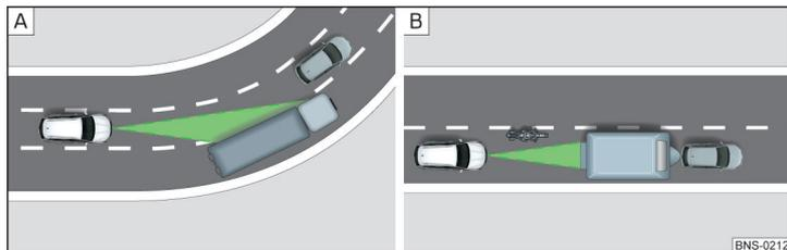
Abb. 282 **Kurvenfahrt / Schmale oder versetzt fahrende Fahrzeuge**
