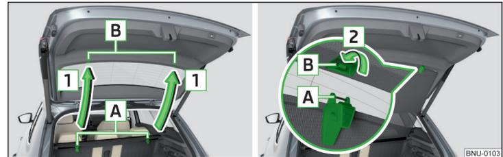
Abb. 141 Aufrollbare Abdeckung an der Gepäckraumklappe befestigen
