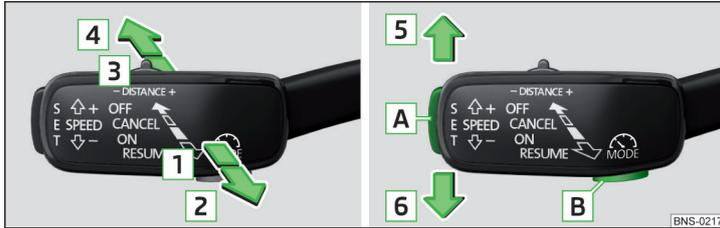
Abb. 278 Bedienungselemente des Geschwindigkeitsbegrenzers (Variante mit ACC)
