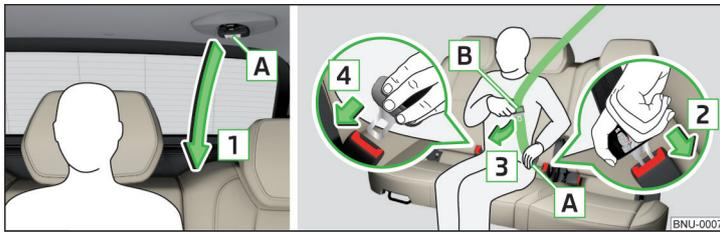
Abb. 19 Sicherheitsgurt auf dem mittleren VarioFlex-Sitz anlegen/ablegen
