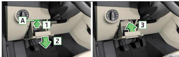
Abb. 337 Ablagefach auf der Fahrerseite
