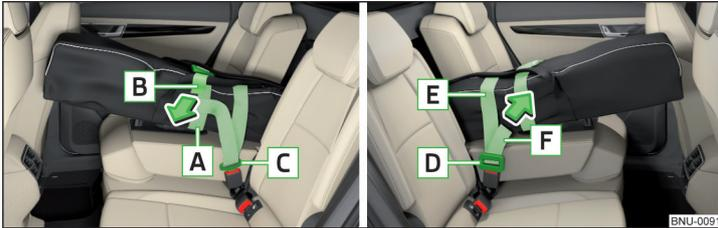
Abb. 120 Sicherung des Durchladesacks
