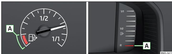
Abb. 32 Kraftstoffvorratsanzeige: Variante 1 / Variante 2
