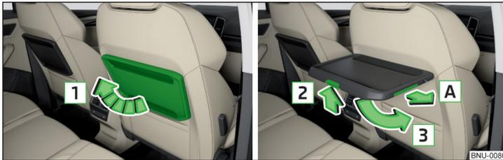
Abb. 118 Tisch hochklappen / Tisch herunterklappen und Getränkehalter herauschieben
