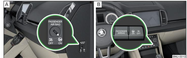
Abb. 23 Schlüsselschalter für Beifahrer-Frontairbag / Kontrollleuchte für Beifahrer-Frontairbag
