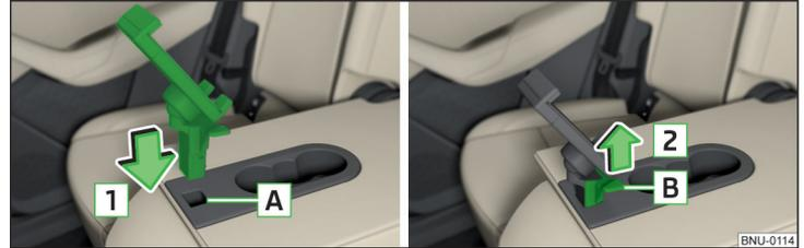
Abb. 129 Halter einsetzen / Halter abnehmen
