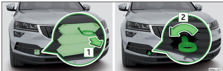
Abb. 324 **Schutzgitter abnehmen / Abschleppöse einbauen**
