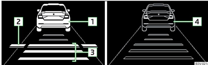
Abb. 279 Display des Kombi-Instruments: Beispiele für ACC-Anzeigen
