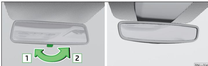
Abb. 76 Innenspiegel: mit manueller Verdunkelung / mit automatischer Verdunkelung
