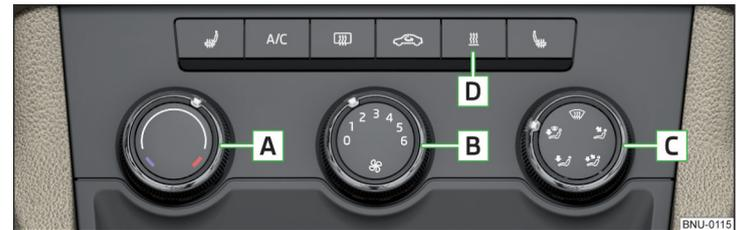
Abb. 152 Bedienelemente der Heizung/Klimaanlage
