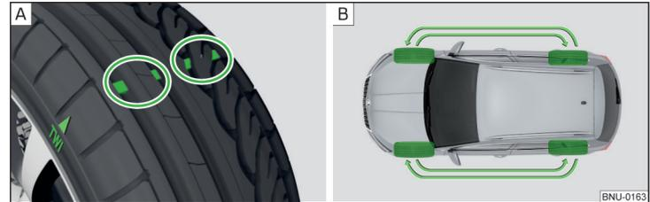
Abb. 309 **Reifenverschleißanzeiger / Rädertausch**
