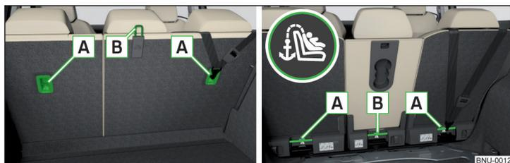
Abb. 28 Halteösen des TOP TETHER-Systems: Variante 1 / Variante 2
