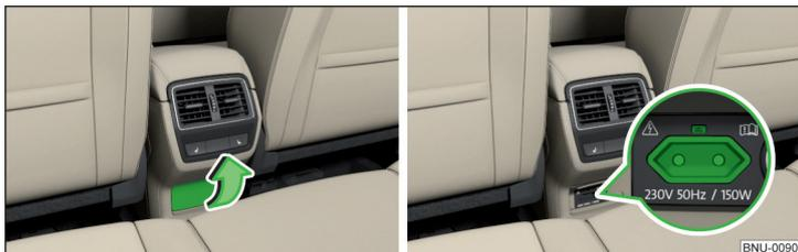
Abb. 124 Abdeckung der 230-Volt-Steckdose aufklappen / 230-Volt-Steckdose
