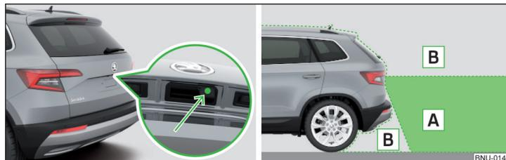
Abb. 266 **Verbauort der Kamera / Abgetasteter Bereich hinter dem Fahrzeug**
