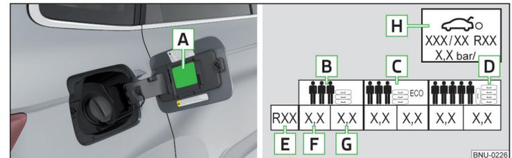
Abb. 308 **Aufkleber mit einer Tabelle der Reifenfülldruckwerte / Reifen aufpumpen**
