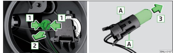
Abb. 344 Glühlampe für Standlicht wechseln
