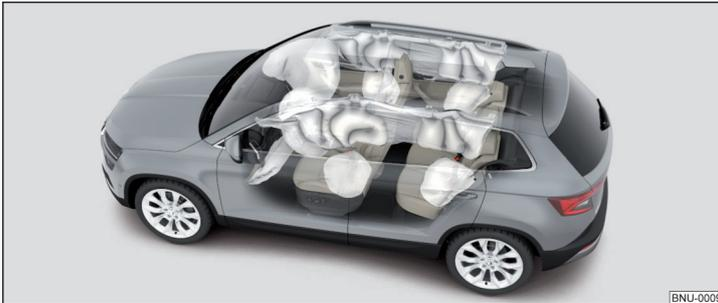
Abb. 21 Gasgefüllte Airbags
