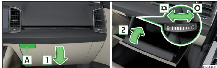
Abb. 113 Ablagefach öffnen / Ablagefach schließen und Luftzufuhr bedienen
