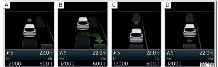
Abb. 270 In eine Längsparklücke einparken: Displayanzeige
