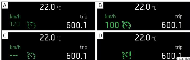
Abb. 273 Display des Kombi-Instruments: Beispiele für Zustandsanzeigen der GRA
