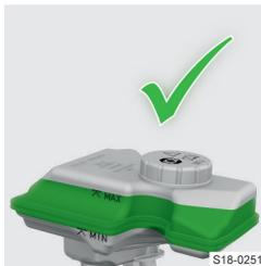
Der Füllstand muss im markierten Bereich liegen.
