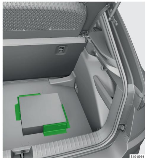
Die maximale Belastung der Cargo-Elemente beträgt 8 kg.
