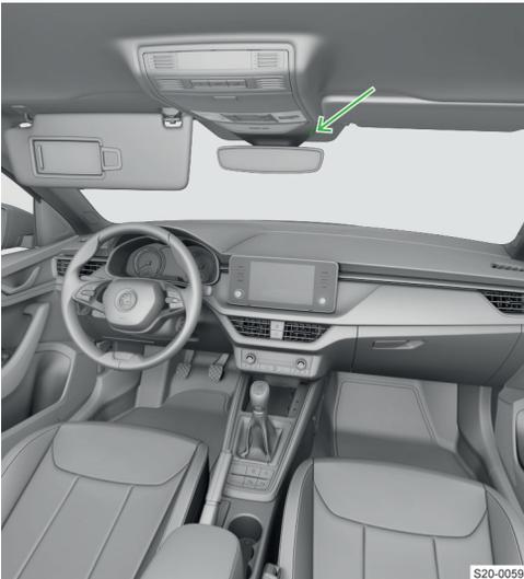
Der USB-Anschluss ist lediglich zum Aufladen verwendbar.
