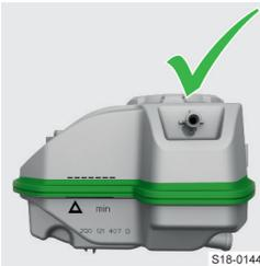
Der Füllstand muss im markierten Bereich liegen.
