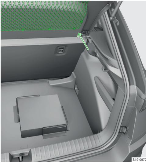
Die maximale Belastung des Netzes beträgt 1,5 kg.
