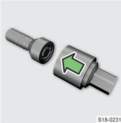
Einige Fahrzeuge können über Anti-Diebstahl-Radschrauben verfügen, die die Räder vor einem Diebstahl schützen.
