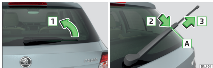
Abb. 279 Scheibenwischerblatt der Heckscheibe auswechseln
