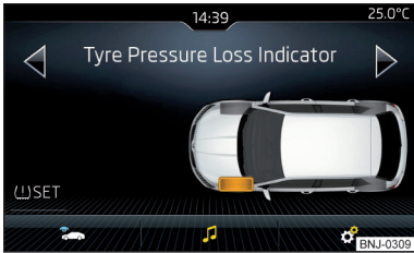
Abb. 230 Taste für Speicherung / Beispiel der Bildschirmanzeige: es wird auf eine Reifendruckänderung vorn links hingewiesen
