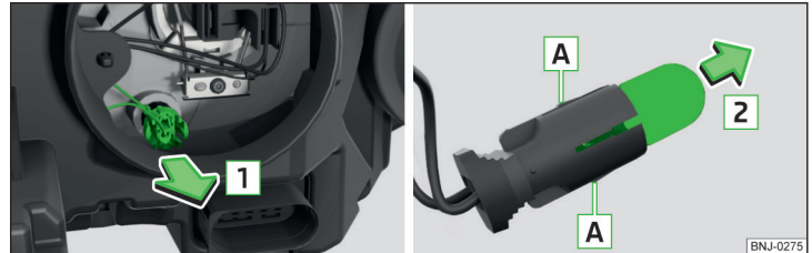
Abb. 300 Glühlampe für Standlicht wechseln
