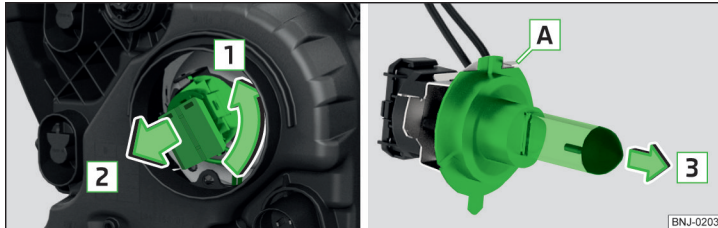
Abb. 303 Glühlampe für Fernlicht wechseln
