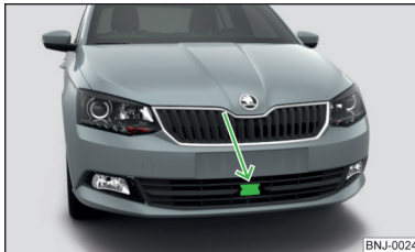
Abb. 217 Verbautort des Radarsensors
