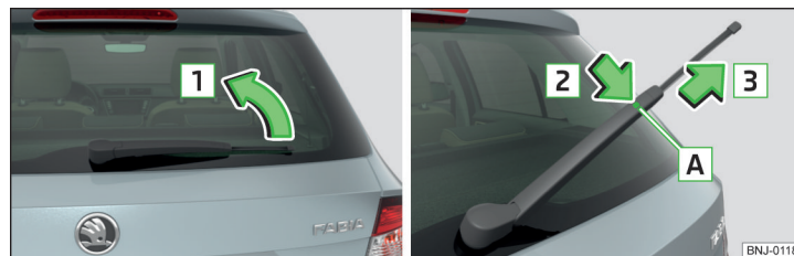
Abb. 289 Scheibenwischerblatt der Heckscheibe auswechseln
