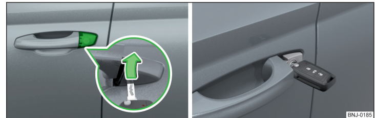
Abb. 283 Griff an der Fahrtür: Schlossabdeckung aufklappen / Schließzylinder mit Schlüssel
