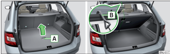
Abb. 117 Variablen Ladeboden hochklappen / Variablen Ladeboden befestigen
