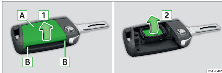
Abb. 282 Abdeckung aufklappen / Batterie herausnehmen
