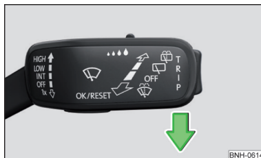
Abb. 287 Servicestellung der Scheibenwischerarme einstellen
