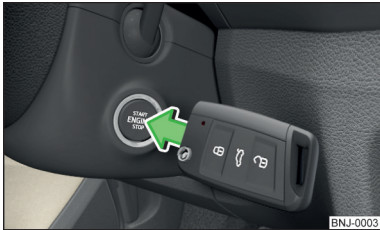
Abb. 207 Motor anlassen - Knopf mit dem Schlüssel drücken
