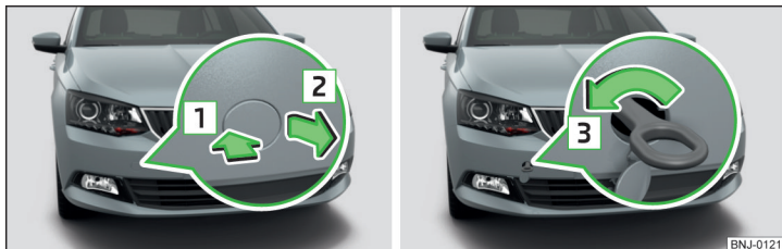
Abb. 280 Abdeckkappe abnehmen / Abschleppöse einbauen
