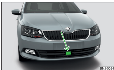
Abb. 220 Verbautort des Radarsensors
