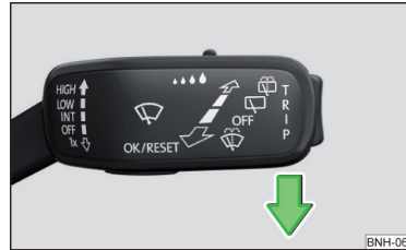
Abb. 292 Servicestellung der Scheibenwischerarme einstellen
