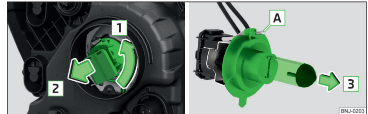
Abb. 308 Glühlampe für Fernlicht wechseln
