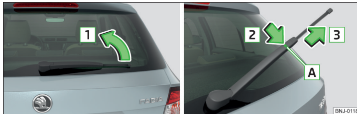
Abb. 294 Scheibenwischerblatt der Heckscheibe auswechseln
