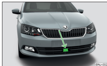
Abb. 125 Verbauort des Radarsensors
