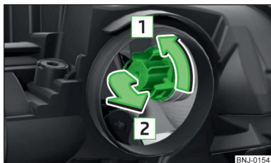
Abb. 209 Glühlampe für Blinklicht vorn wechseln
