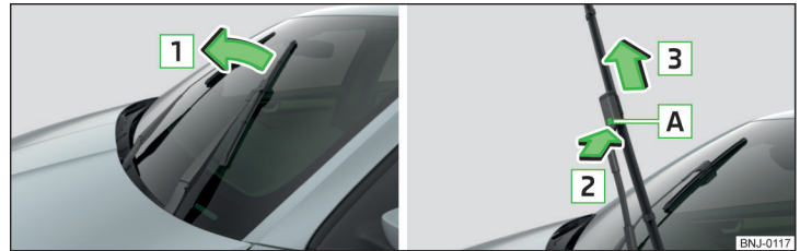
Abb. 198 Scheibenwischerblatt der Frontscheibe austauschen
