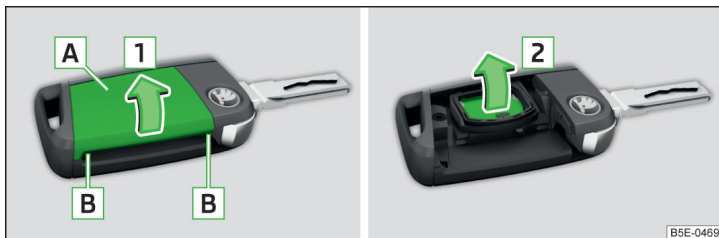
Abb. 192 Abdeckung abnehmen / Batterie herausnehmen
