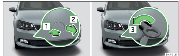
Abb. 190 Abdeckkappe abnehmen / Abschleppöse einbauen
