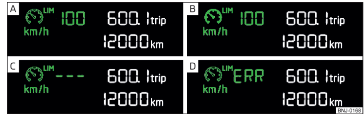
Abb. 138 Segmentdisplay: Beispiele für Zustandsanzeigen des Geschwindigkeitsbegrenzers
