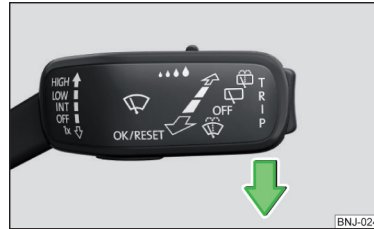
Abb. 197 Servicestellung der Scheibenwischerarme einstellen
