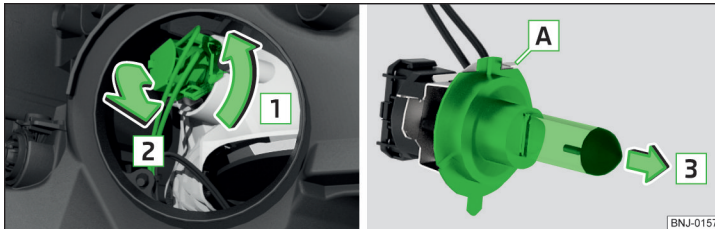
Abb. 212 Glühlampe für Ablendlicht wechseln
