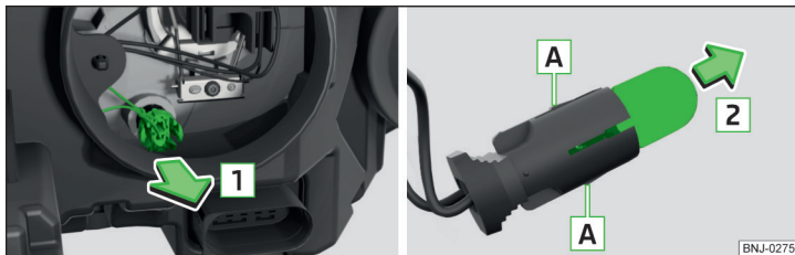
Abb. 210 Glühlampe für Standlicht wechseln
