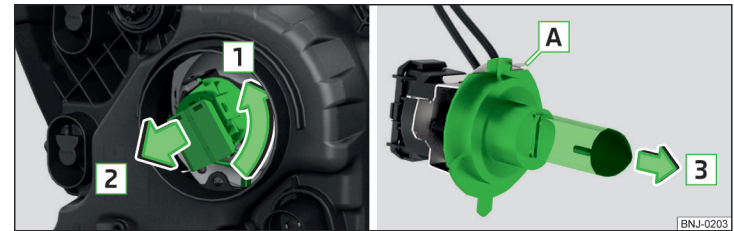
Abb. 213 Glühlampe für Fernlicht wechseln
