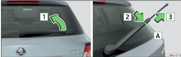
Abb. 199 Scheibenwischerblatt der Heckscheibe auswechseln
