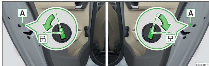
Abb. 194 Notverriegelung: Tür hinten links/rechts
