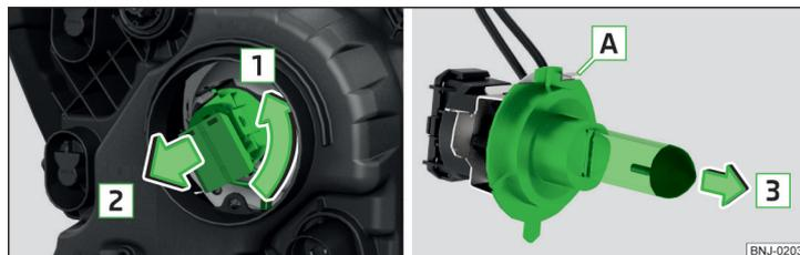
Abb. 213 Glühlampe für Fernlicht wechseln
