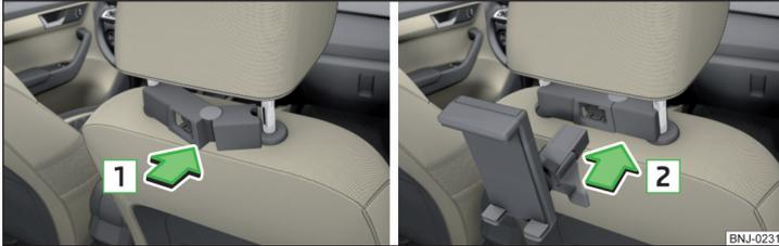
Abb. 85 Einsetzen: Adapter / Halter
