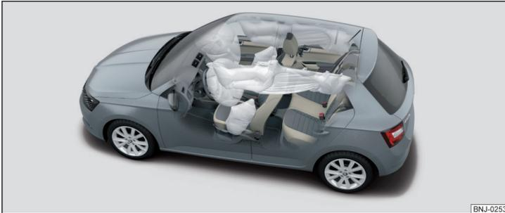
Abb. 8 Gasgefüllte Airbags
