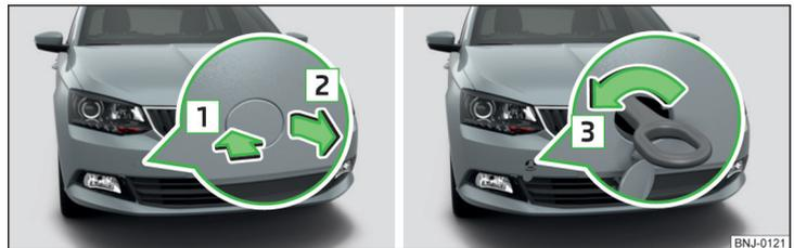
Abb. 190 Abdeckkappe abnehmen / Abschleppöse einbauen
