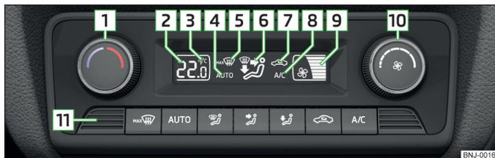
Abb. 112 Bedienungselemente der Climatronic
