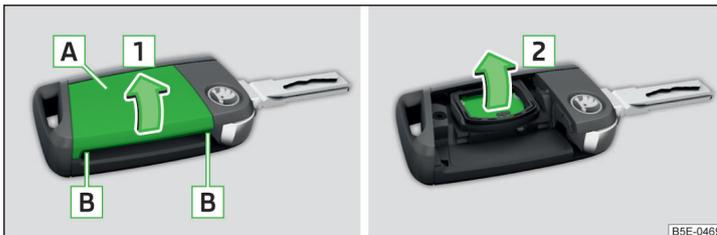
Abb. 192 Abdeckung abnehmen / Batterie herausnehmen
