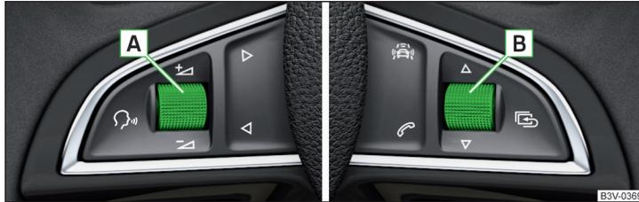
Abb. 25 Tasten/Einstellräder am Multifunktionslenkrad
