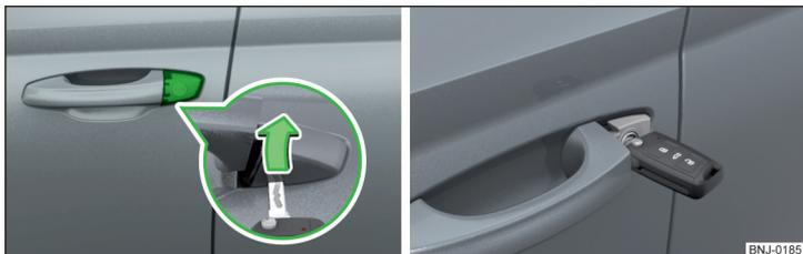
Abb. 193 Griff an der Fahrertür: Schlossabdeckung aufklappen / Schließzylinder mit Schlüssel
