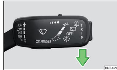
Abb. 197 Servicestellung der Scheibenwischerarme einstellen
