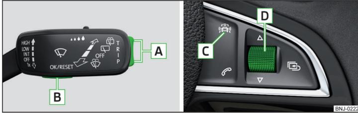
Abb. 147 Tasten/Einstellrad: am Bedienungshebel / am Multifunktionslenkrad
