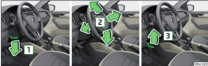
Abb. 3 Lenkradposition einstellen
