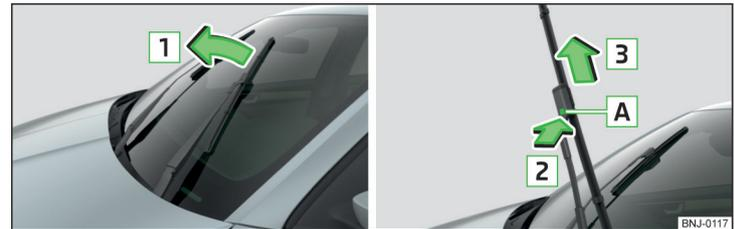
Abb. 198 Scheibenwischerblatt der Frontscheibe austauschen
