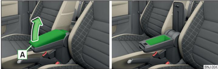
Abb. 75 Ablagefach öffnen / Ablagefach
