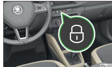
Abb. 32 Zentralverriegelungstaste
