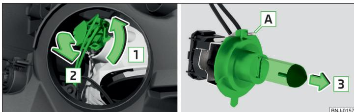
Abb. 212 Glühlampe für Abblendlicht wechseln
