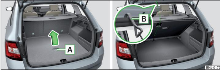
Abb. 104 Variablen Ladeboden hochklappen / Variablen Ladeboden befestigen
