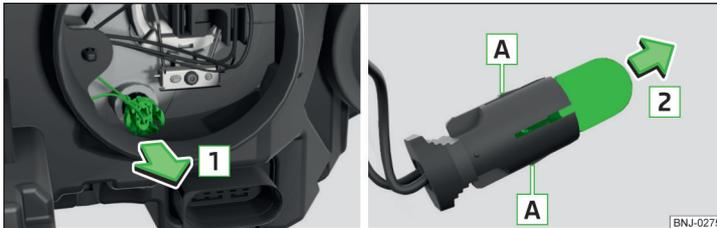
Abb. 210 Glühlampe für Standlicht wechseln
