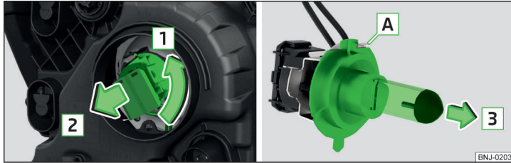
Abb. 202 Glühlampe für Fernlicht wechseln
