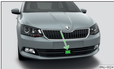
Abb. 135 Einbauort des Radarsensors
