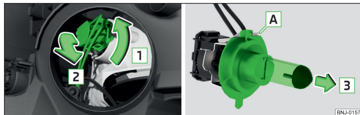
Abb. 201 Glühlampe für Abblendlicht wechseln
