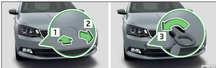
Abb. 181 Ausbau der Abdeckkappe / Einbau der Abschleppöse
