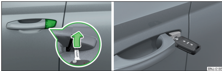
Abb. 184 Griff an der Fahrtür: abgedeckter Schließzylinder / Schließzylinder mit Schlüssel
