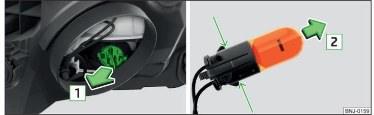
Abb. 191 Glühlampe für Blinklicht wechseln
