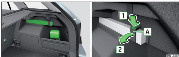
Abb. 155 Verbandskasten und Warndreieck - Variante 2 / Befestigungsband lösen
