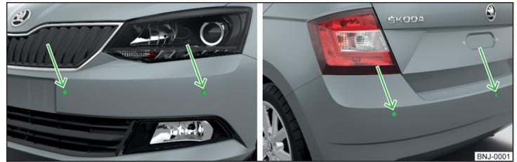
Abb. 115 Einbauort der Ultraschall-Sensoren: vorn/hinten
