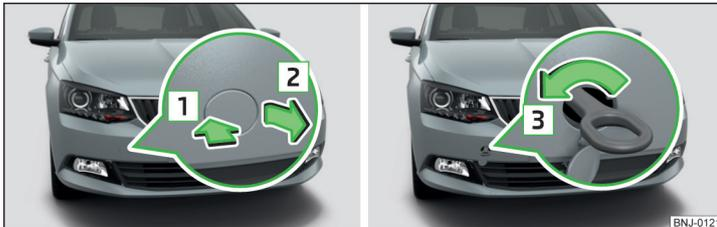
Abb. 169 Ausbau der Abdeckkappe / Einbau der Abschleppöse
