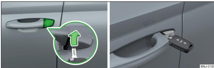
Abb. 172 Griff an der Fahrtür: abgedeckter Schließzylinder / Schließzylinder mit Schlüssel
