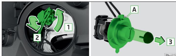
Abb. 189 Glühlampe für Ablendlicht wechseln
