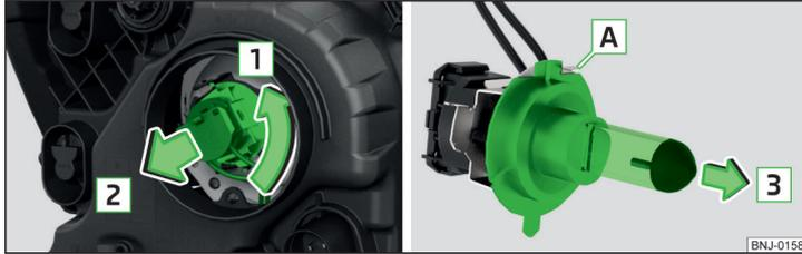
Abb. 190 Glühlampe für Fernlicht wechseln
