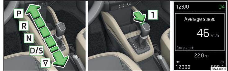
Abb. 110 Wählhebel / Sperrtaste / Displayanzeige
