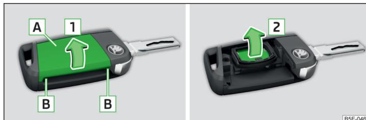
Abb. 171 Abdeckung abbauen / Batterie herausnehmen
