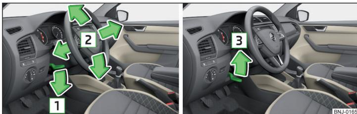
Abb. 2 Lenkradposition einstellen
