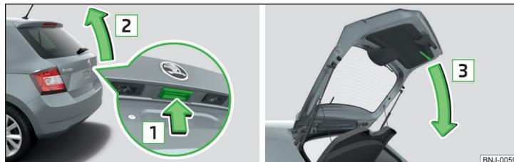
Abb. 37 Gepäckraumklappe öffnen/schließen
