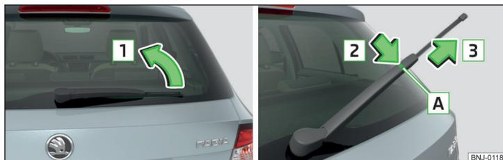
Abb. 177 Scheibenwischerblatt der Heckscheibe
