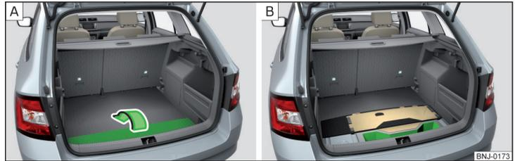
Abb. 89 Boden umklappen / Ablagefach unter dem Boden
