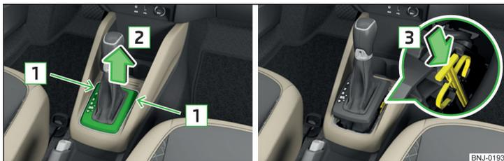
Abb. 175 Wählhebel-Notentriegelung
