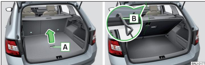
Abb. 94 Variablen Ladeboden hochklappen / Variablen Ladeboden befestigen
