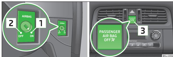
Abb. 12 Schlüsselschalter für Beifahrer-Frontairbag / Kontrollleuchte für Beifahrer-Frontairbagab/-einschaltung
