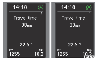
Abb. 115 MAXI DOT-Display: Motor ist automatisch abgeschaltet / automatische Motorabschaltung ist nicht möglich
