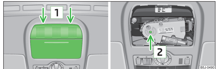
Abb. 39 Ansatzpunkt des Schraubendrehers / Öffnung zum Ansetzen des Schlüssels
