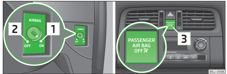
Abb. 12 Schlüsselschalter für Beifahrer-Frontairbag / Kontrollleuchte für Beifahrer-Frontairbagab/-einschaltung
