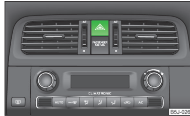
Abb. 27 Schalttafel: Taste für Warnblinkanlage
