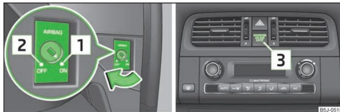
Abb. 106 Schlüsselschalter für Beifahrer-Frontairbag / Kontrollleuchte für Beifahrer-Frontairbagabschaltung
