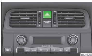
Abb. 24 Schalttafel: Schalter für Warnblinkanlage
