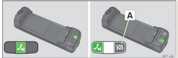
Abb. 91 Prinzipdarstellung: Adapter mit einer Taste / Adapter mit zwei Tasten
