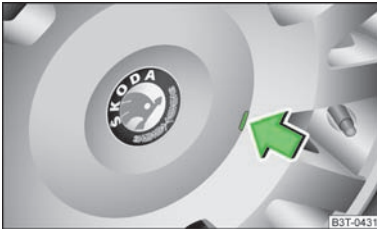
Abb. 129 Radzierkappe bei Leichtmetall- rädern abziehen
