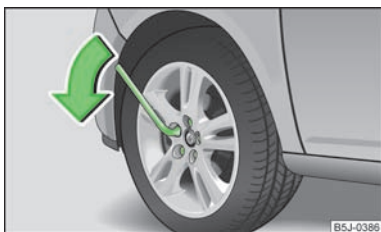
Abb. 133 Radwechsel: Radschrauben lösen
