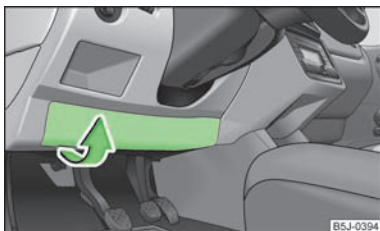
Abb. 142 Unterseite der Schalttafel: Abdeckung des Sicherungskastens
