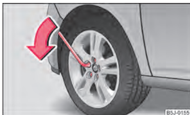
Abb. 142 Radwechsel: Radschrauben lösen
