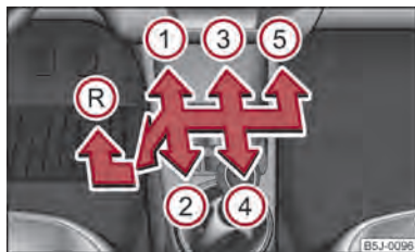
Abb. 83 Schaltschema bei Fahrzeugen mit 5-Gang Schaltgetriebe
