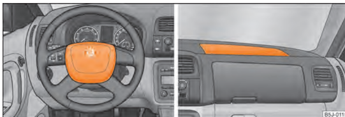
Abb. 102 Fahrer-Airbag im Lenkrad / Beifahrer-Airbag in der Schalttafel
