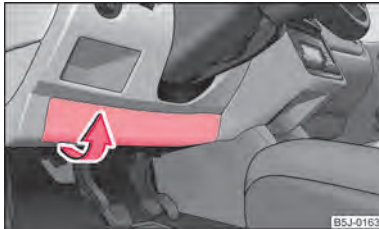
Abb. 151 Untere Seite der Schalttafel: Sicherungsdeckel
