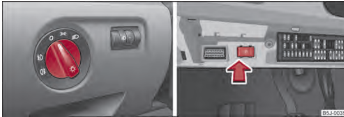
Abb. 22 Schalttafel: Lichtschalter / Sicherungsfach: Schalter für Tagfahrlicht
