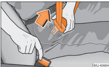
Abb. 114 Lösen der Schlosszunge vom Gurtschloss
