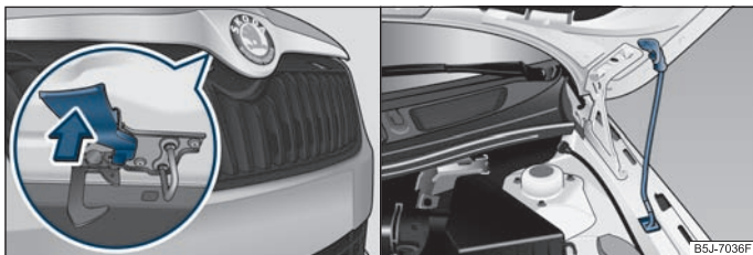
Abb. 140 Kühlergrill: Sicherungshebel / Sicherung der Motorraumklappe mit der Klappenstütze
