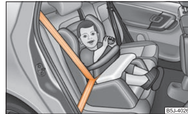
Abb. 126 In Fahrtrichtung eingebauter Kindersitz mit Sicherheitstisch der Gruppe 1 auf der Rücksitzbank
