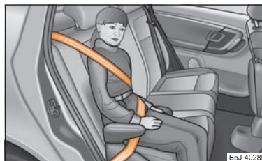
Abb. 128 In Fahrtrichtung eingebauter Kindersitz der Gruppe 3 auf dem Rücksitz
