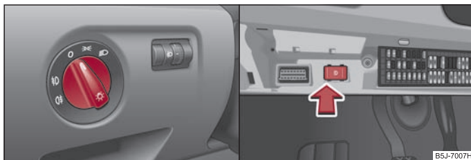
Abb. 35 Schalttafel: Lichtschalter / Sicherungsfach: Schalter für Tagfahrlicht
