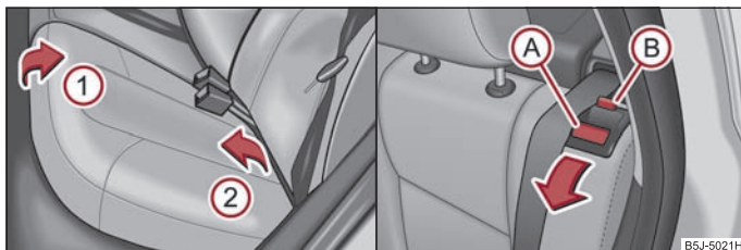
Abb. 54 Sitzfläche vorklappen / Sitzlehne entriegeln
