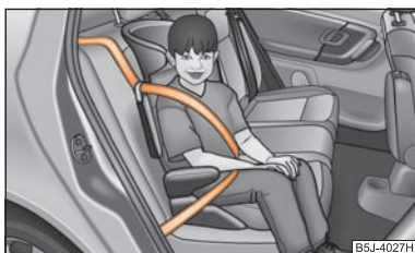
Abb. 127 In Fahrtrichtung eingebauter Kindersitz der Gruppe 2 auf dem Rücksitz
