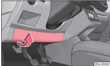
Abb. 163 Untere Seite der Schalttafel: Sicherungsdeckel
