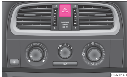
Abb. 37 Schalttafel: Schalter für Warnblinkanlage
