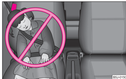
Abb. 148 Das nicht richtig gesicherte Kind in nicht richtiger Sitzposition - gefährdet durch den Seiten-Airbag
