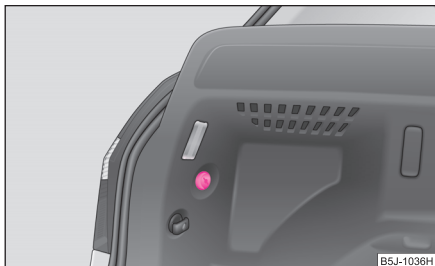
Abb. 181 Heckleuchten- einheit ausbauen
