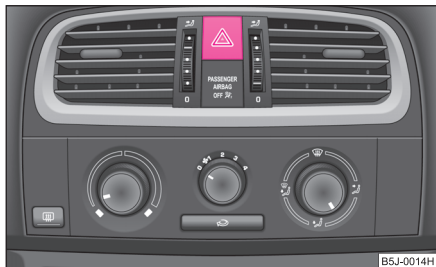
Abb. 37 Schalttafel: Schalter für Warnblink- anlage
