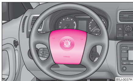
Abb. 114 Fahrer-Airbag im Lenkrad
