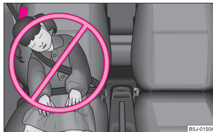
Abb. 125 Das nicht richtig gesicherte Kind in nicht richtiger Sitzposition – gefährdet durch den Seiten-Airbag
