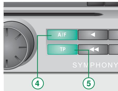
TP-Programme sind im Display durch die Anzeige ㉒ **TP** gekennzeichnet. Die Wiedergabe einer Verkehrsmeldung wird im Display durch „**INFO PRGNAME**“ angezeigt. Ist das eingestellte TP-Programm nicht mehr zu empfangen, stellt das Gerät automatisch das nächste gut empfangbare TP-Programm ein. In der Anzeige erscheint dabei **NO TP TP SEEK**. Sollten Sie keine Verkehrsmeldungen wünschen, empfangen Sie das gewünschte Programm in einem der FM-Bereiche (FM 1 oder FM 2).
