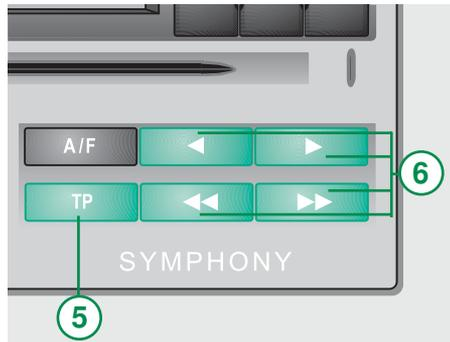
Durch längeres Drücken der Taste ⑤ TP gelangen Sie in das Setup-Menü. Hier werden spezielle Einstellungen, wie z. B. Betrieb des Autoradios in Verbindung mit einem Telefon, vorgenommen.
