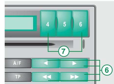
TP gespeichert. Sofern Sie "Beep" im Setup-Menü aktiviert haben, wird der Speichervorgang akustisch quittiert. Das gespeicherte Programm ist nun immer wieder durch Drücken der entsprechenden Stationstaste 7 aufrufbar.
