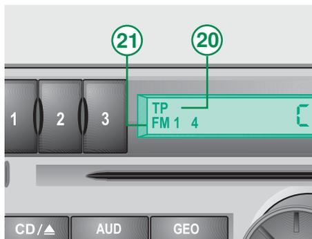
Ihr Radiogerät ist mit je einem Empfangsteil für das FM- und AM-Band ausgestattet. Es stehen jeweils 6 Speicherplätze in den Bereichen FM 1, FM 2 und TP sowie im AM-Bereich jeweils 6 Speicherplätze in den Bereichen AM 1 und AM 2 zur Verfügung. Der gewählte Bereich wird im Display, Position ⑳ angezeigt.
