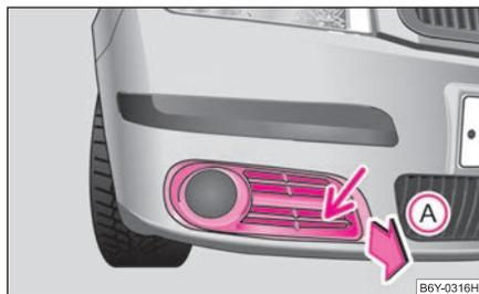
Abb. 162 Vorderer Stoßfänger: Schutzgitter
