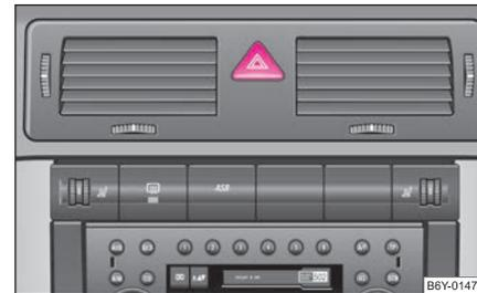
Abb. 35 Schalttafel: Schalter für Warnblinkanlage
