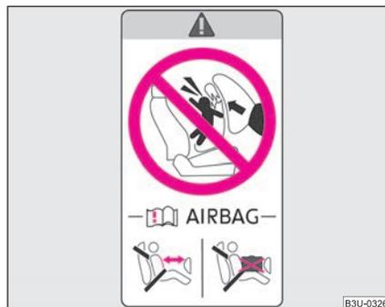
**Abb. 121** Aufkleber an der mittleren Karoseriesäule auf der Beifahrersseite
