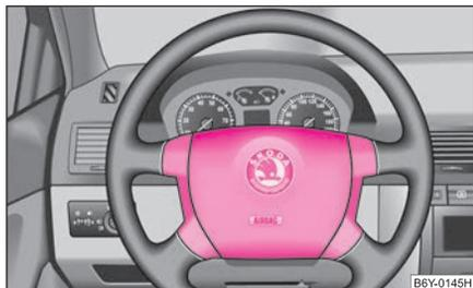
Abb. 113 Fahrer-Airbag im Lenkrad
