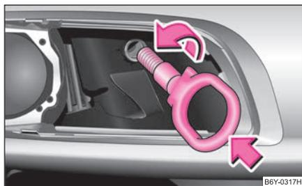
Abb. 163 Vorderer Stoßfänger: Einbau der Abschleppöse
