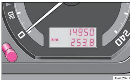
Abb. 3 Kombiinstrument: Zähler für zurückgelegte Fahrstrecke
