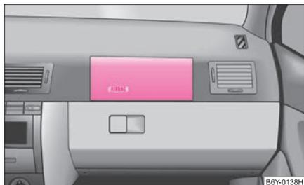
Abb. 114 Beifahrer-Airbag in der Schalttafel
