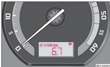
Abb. 6 Display im Drehzahlmesser: Multifunktionsanzeige
