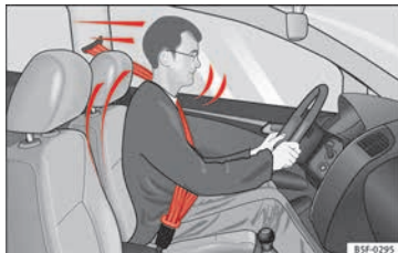
Abb. 75 Richtig angegurtete Fahrer werden bei einem plötzlichen Bremsmanöver nicht nach vorne geschleudert.
