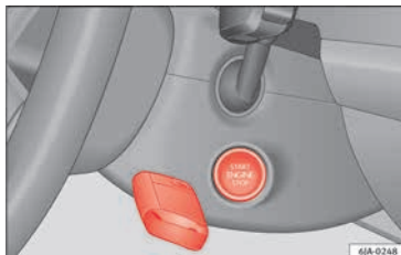
Abb. 174 Notstart bei Fahrzeugen mit Keyless Access.
