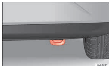
Abb. 66 Hinterer Stoßfänger, rechte Seite: Abschleppöse.
