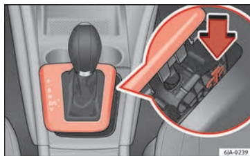
Abb. 44 Notentriegeln der Wählhebelsperre
