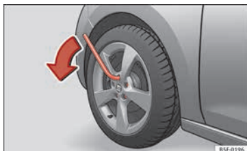
Abb. 62 Radwechsel: Radschrauben lockern
