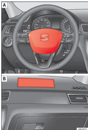
Abb. 15 Fahrerairbag im Lenkrad und Beifahrerairbag in der Instrumententafel
