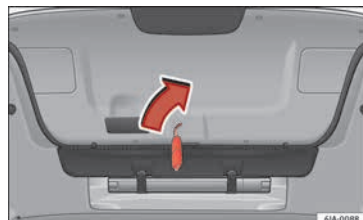
Abb. 6 Ausschnitt Gepäckraum: Zugang zur Notentriegelung
