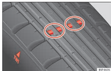
Abb. 213 Reifenprofil mit Verschleißanzeiger.
