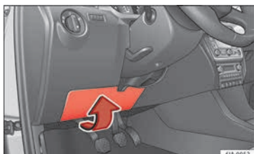
Abb. 54 Auf der Fahrerseite in der Instrumententafel: Abdeckung des Sicherungskastens.
