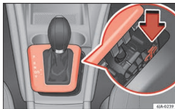
Abb. 45 Notentriegeln der Wählhebelsperre
