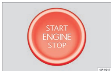
Abb. 174 In der Lenksäule: Starterknopf des schlüssellosen Schließ- und Startsystem Keyless Access. Bei Rechtslenker-Fahrzeugen ist die Anordnung symmetrisch.
