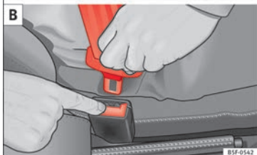
Abb. 79 Schlosszunge des Sicherheitsgurts in das Gurtschloss einstecken und vom Gurtschloss lösen.
