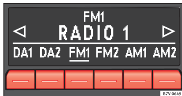
Abb. 2 Hauptmenü RADIO: Speicherebene und Frequenzbereich auswählen.
