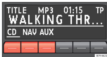
Abb. 19 Media-Auswahlmenü: eine CD aus dem internen CD-Laufwerk wird gespielt.
