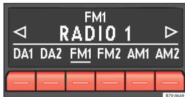
Abb. 7 Frequenzbereich und Speicherebene auswählen.
